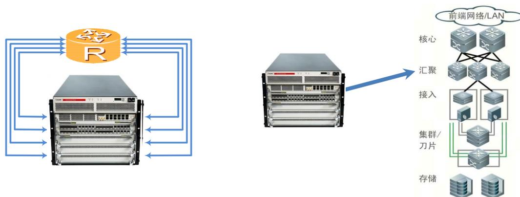
图 1 基于 5201 的 2~3 层流量测试示意图
