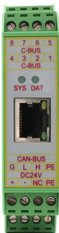
图 2.3 GCAN-302 模块接线端子排
