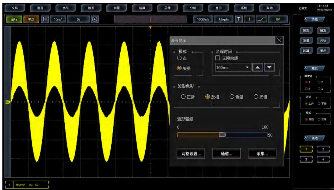
图3.64 反相调色板显示调幅波
