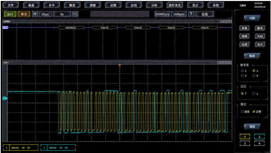
图3.149 I2C 触发与分析示例
