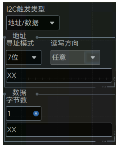
图3.148 地址/数据触发类型设置
