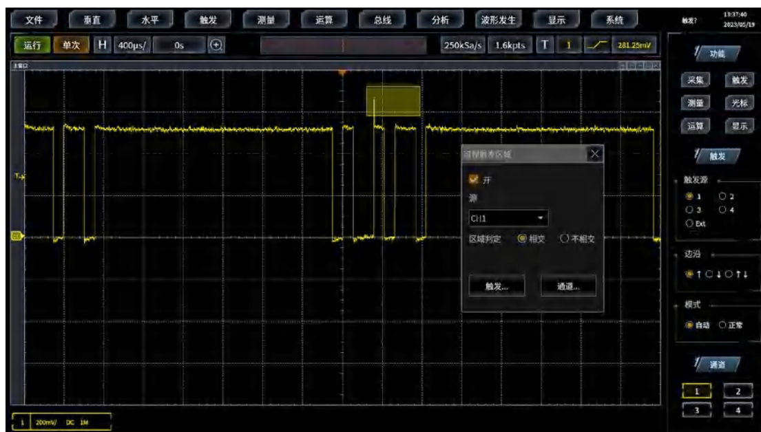
可视触发：迅速实现波形触发定位
