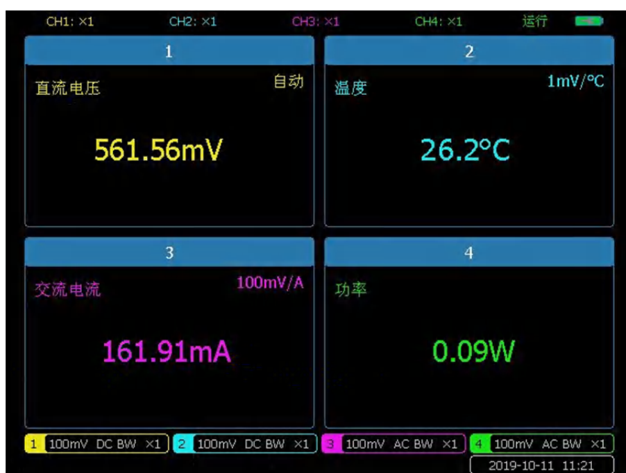
四通道机型电压、电流（电流探头）、温度（温度探头）、功率等多种模拟量测量
