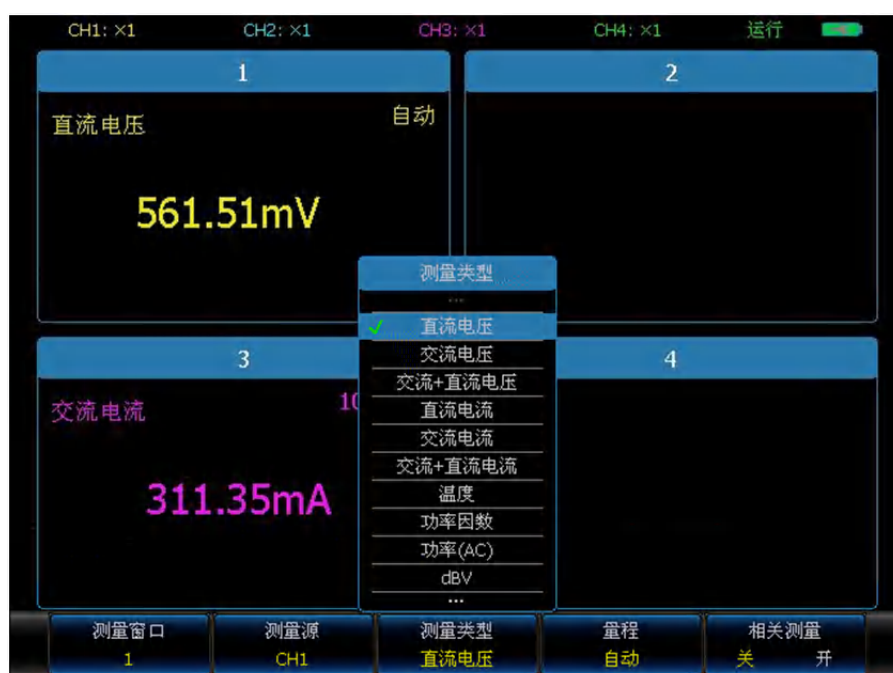
四通道机型直流电压、交流电压、交流+直流电压测量
