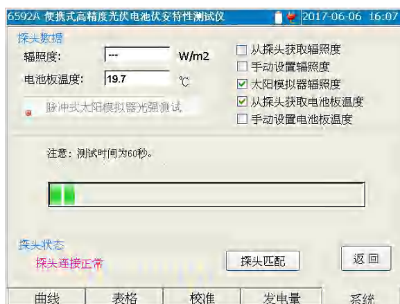
图 5-32 脉冲式太阳模拟器光强测试示意图
