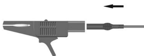
图 4-5 测试线与鳄鱼夹连接示意图
