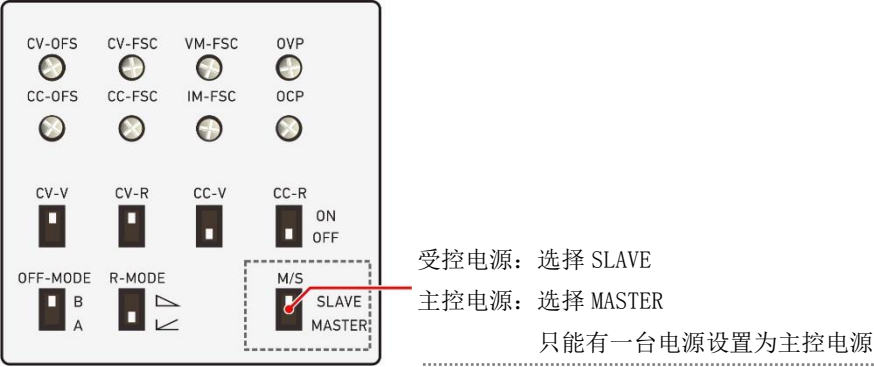
图 5-16 主控、受控电源并联设置
