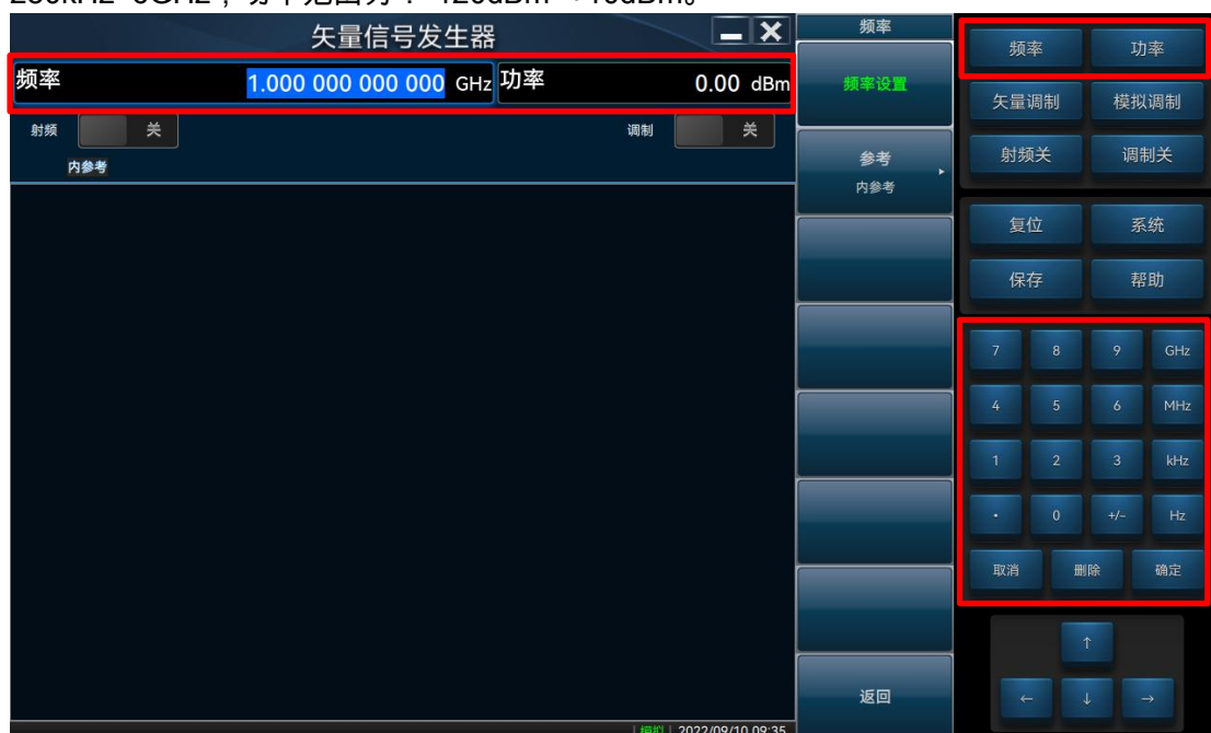
图 4.1 6939 矢量信号发生器频率功率设置
