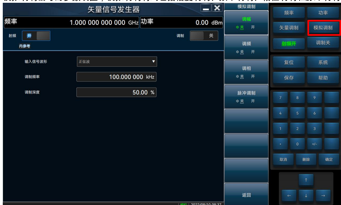
图 4.9 6939 矢量信号发生器模拟调制设置界面
