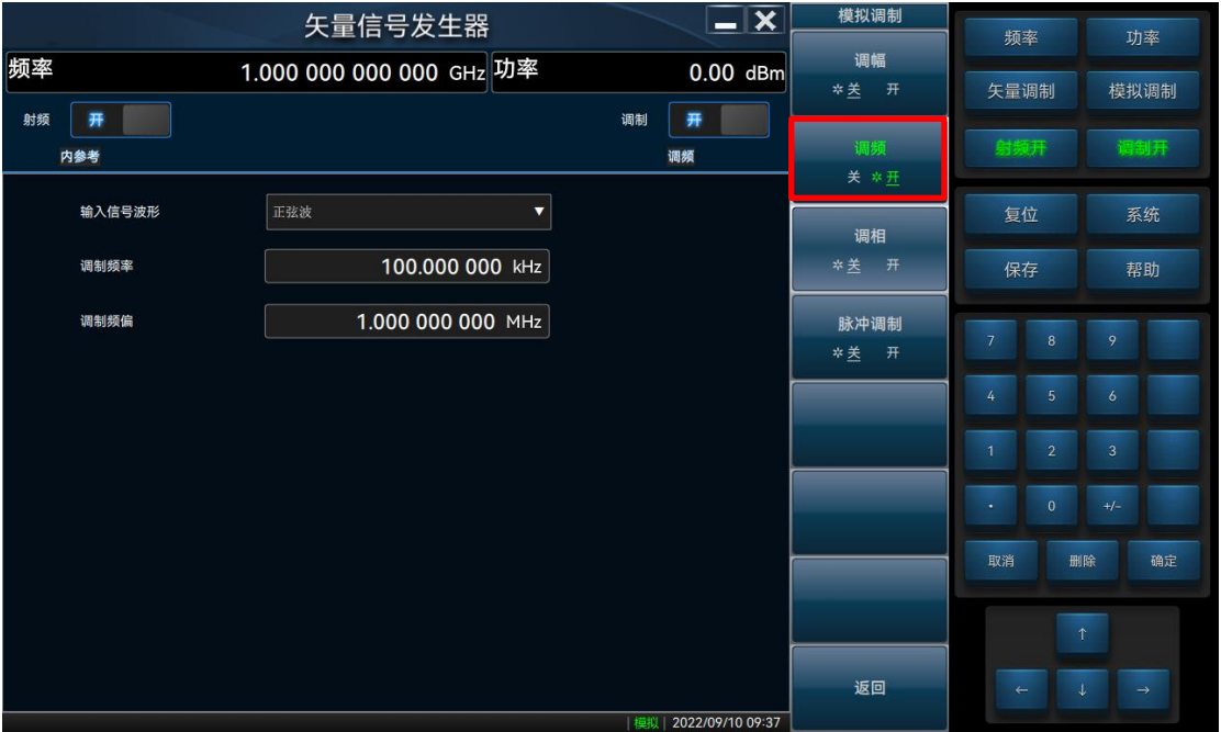
图 4.10 6939 矢量信号发生器频率调制设置
