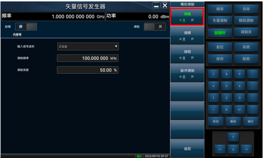
图 4.9 6939 矢量信号发生器幅度调制设置
