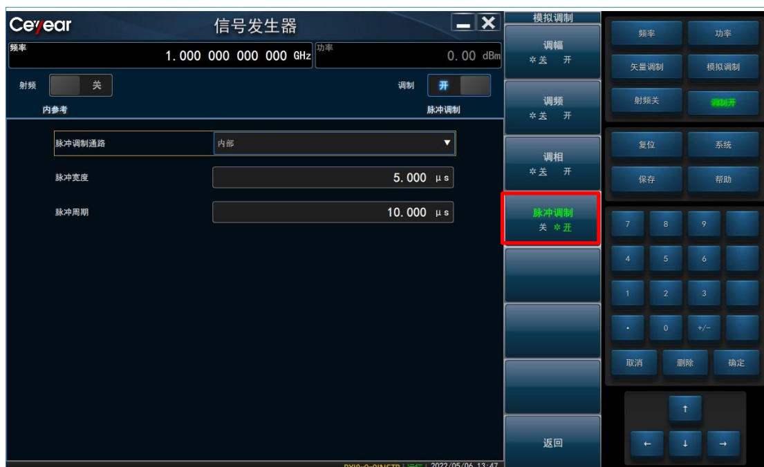
图 4.12 6939 矢量信号发生器脉冲调制设置
