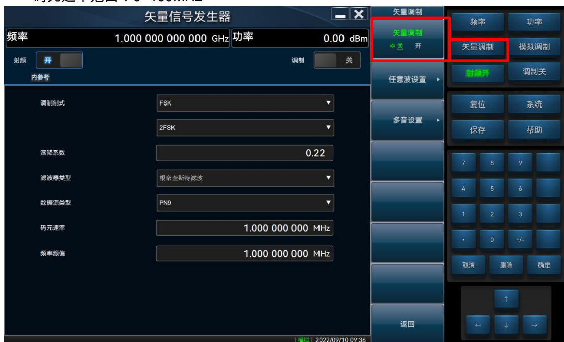
图 4.3 6939 矢量信号发生器矢量调制设置
