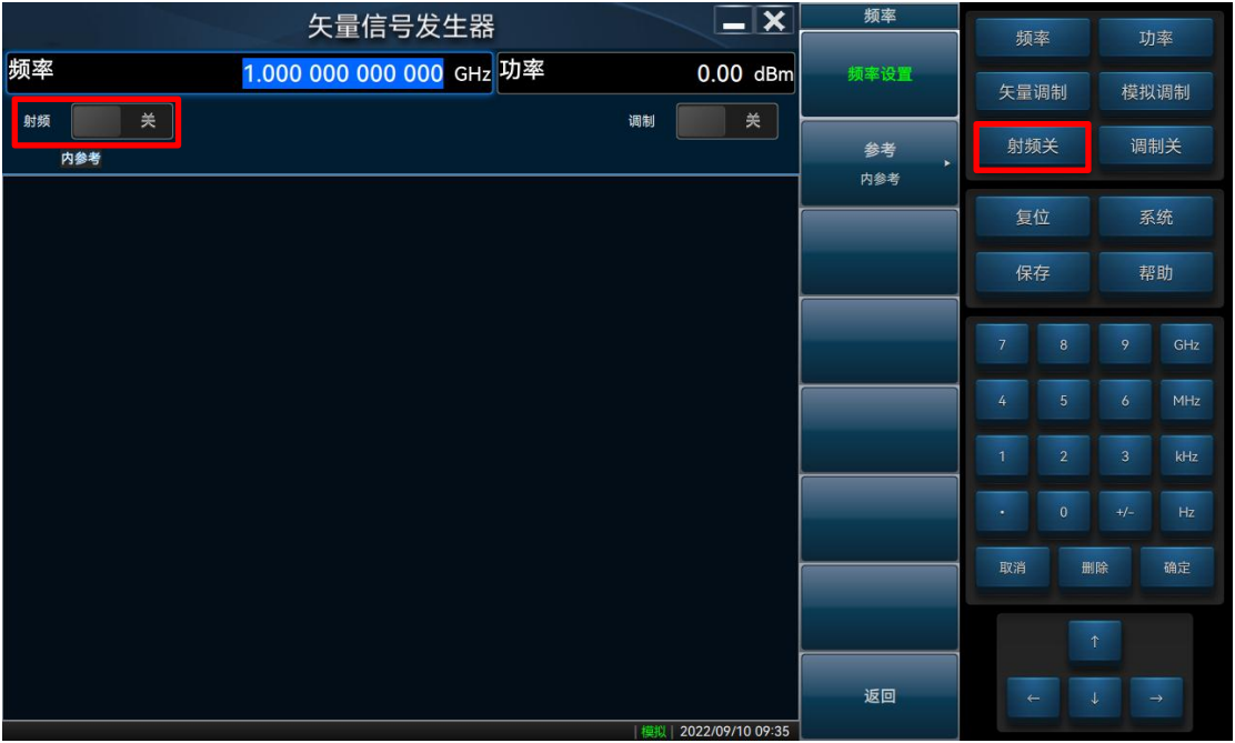
图 4.2 6939 矢量信号发生器射频通断设置
