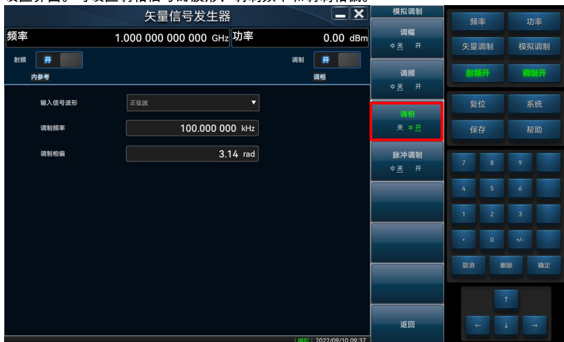
图 4.11 6939 矢量信号发生器相位调制设置
