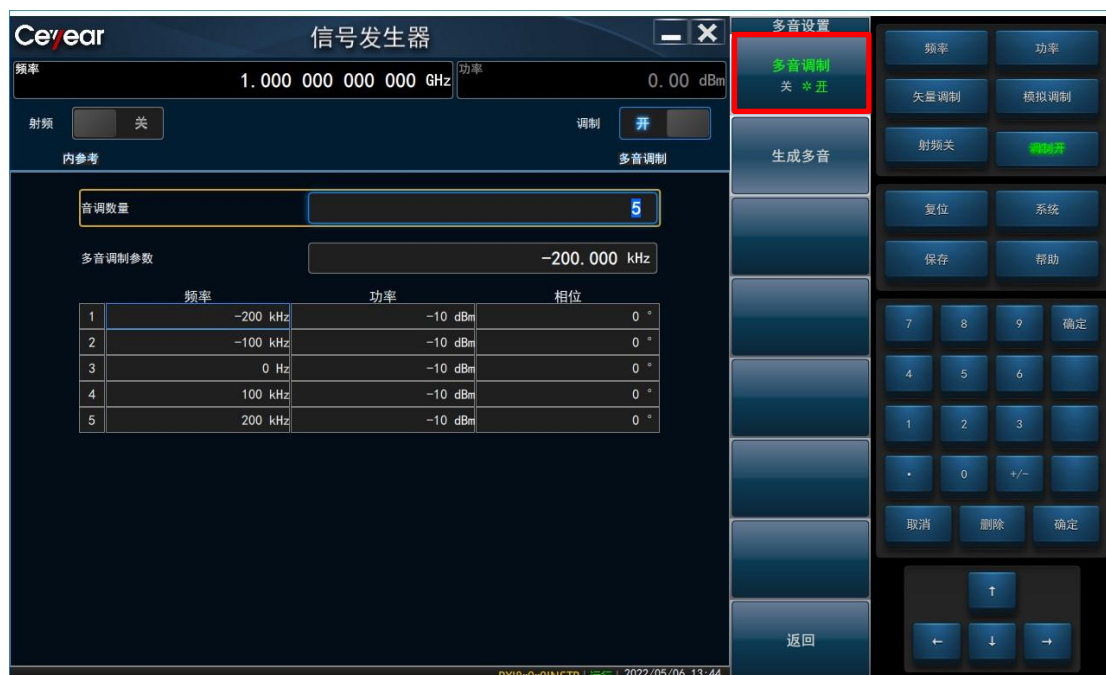
图 4.6 6939 矢量信号发生器多音信号设置界面
