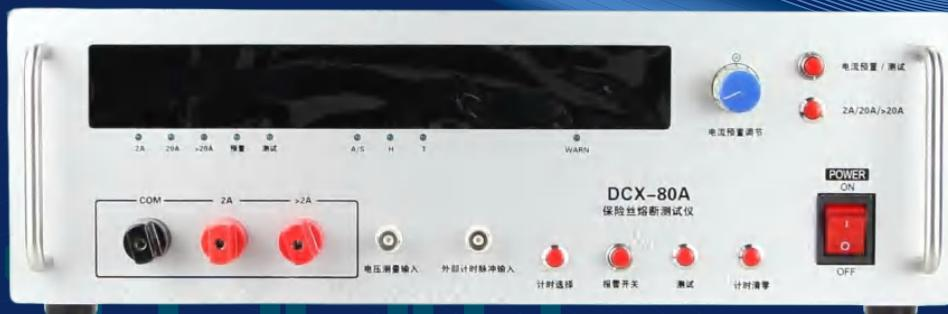
**DCX**系列保险丝测试仪，是一款采用最新功率变换元件的高功率密度，为保险丝及过流保护电气行业，根据相关GB\CCC标准要求，深度开发的产品。界面简洁易操作，齐全的保护功能，人性化的设计，能够满足不同客户的需求。
