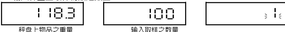
☰ 总数栏数字闪烁时间约 6 秒钟,若闪烁结束前未按 **个数设定** 键,则电子秤自动于闪烁结束后,完成单重设定程序,并且自动将单重栏所输入之数值视为取样物品之单重,并以该单重计算取样物品之数量于数量栏。
