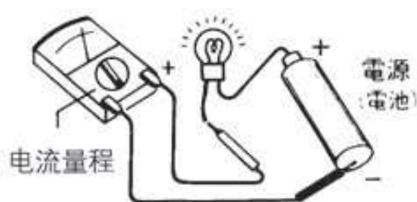
测量电灯消耗的电流
