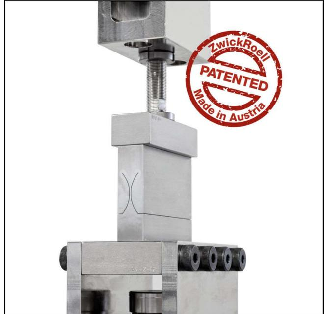
Patentiertes verschleißfreies elastisches Gelenk
