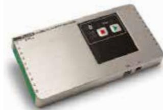
**TP6200** - 20点热电偶输入,与多种隔热箱兼容。TP6200最多可订购四项模拟输入和多种热电偶类型,适用于复杂的高温曲线分析应用。
