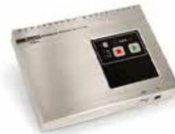
**TP6300** - 20点热电偶输入,具有易于使用的格式,并具有与TP6200相同的规格。本装置还兼容一系列隔热箱(包括我们的密封淬火和柱形隔热箱)。
