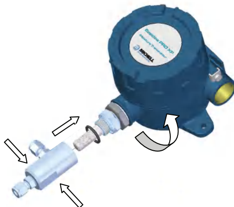
图 8 变送器安装 - 样品块
