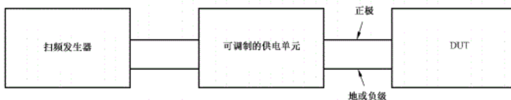
图 1 叠加交流电压试验布置示意图
