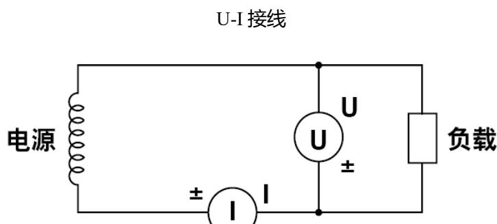
当测试小电流时需要采用 U-I 接线方式，测试大电流时采用 I-U 的接线方式。
