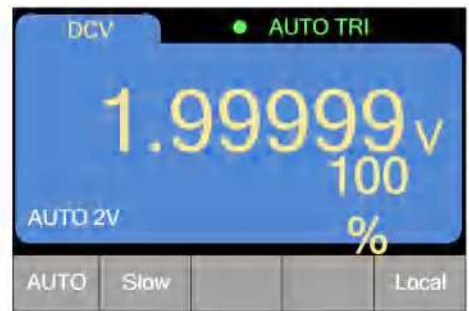
图 2.1.1 直流电压测量界面
