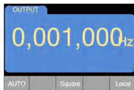
图 2.8.1 默认输出 1kHz 频率方波界面
