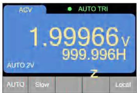
图 2.1.3 交流电压测量界面
