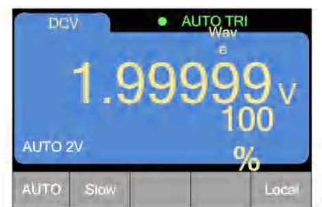
图 2.8.5 从方波输出切换到直流电压测量后的界面
