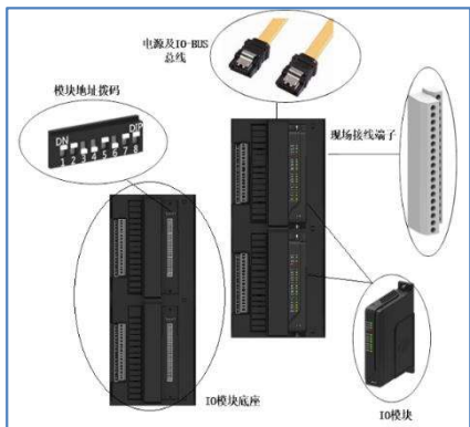
图 4-72 DI6411模块单元结构图
