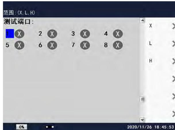
在此界面下，可以设置多路端口输出的状态，“H”：此端口有高压输出，“L”：此端口与返回端“RET”相通，“X”此端口关闭。（此界面只有耐压多路测试仪才有，具体通道数详见技术参数）
