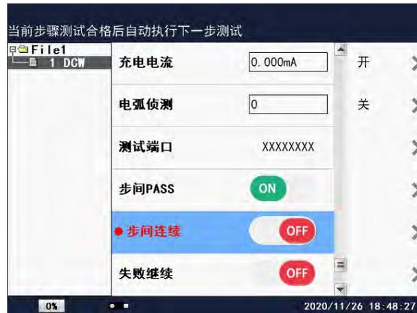
当设置完开时，当前步测试完成后，测试仪会继续下一步的测试；设置为关，当前步测试完成后，测试仪停止测试，直至按下“START”键再进行下一步的测试。
