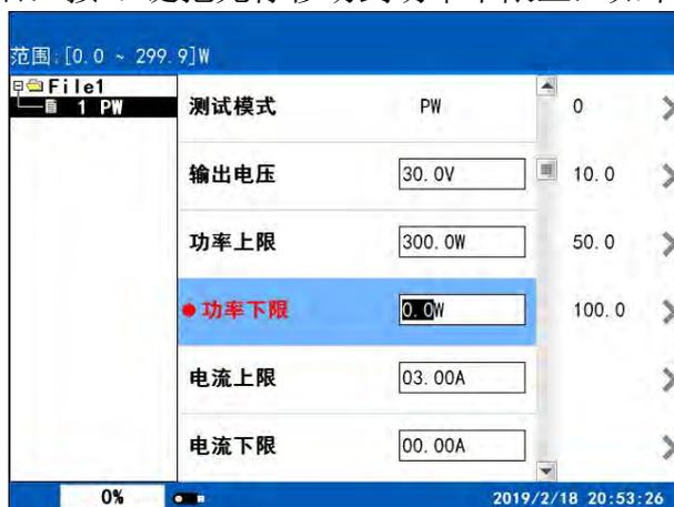
在此界面下，按相应的数字键或对应的屏幕键即可改变功率下限值。不同型号的测试仪，其功率下限值的范围是不同的，在液晶屏的左上角有设置值的范围值。输入的功率下限值在范围内是有效的，否则无效。例如：要设置 50.0W 的功率下限值，按“5”、“0”、“.”、“0”即可。
