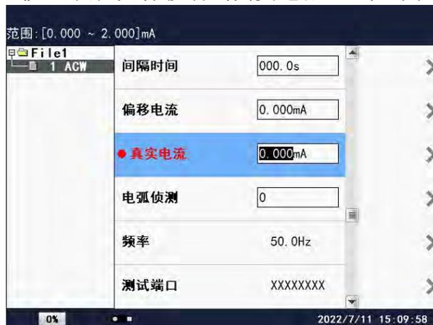
在此界面下，按相应的数字键或对应的屏幕键即可改变真实电流设置值。真实电流是流过被测试体电阻部分的电流。
