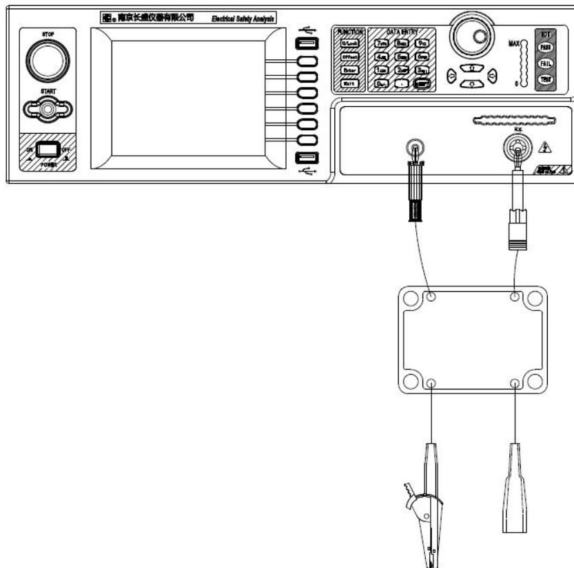
CS26009-2-4L (2 个) 接线示意图, 如下图示:
