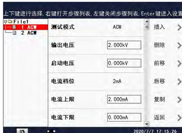
步骤操作包括：步骤插入；步骤删除；步骤前移；步骤后移；步骤复制。
