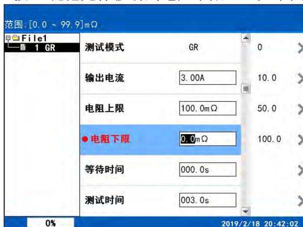
在此界面下, 按相应的数字键或对应的屏幕键即可改变电阻下限值。不同型号的测试仪, 其电阻下限的范围是不同的, 在液晶屏的左上角有设置值的范围值。例如: 要输出  $10.0\text{m}\Omega$  的电阻上限值, 按“1”、“0”、“.”、“0”、即可。当测试仪测试的电阻值小于电阻下限值时, 测试仪报警并切断输出。
