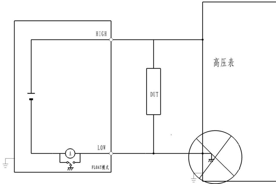
错误接法，FLOAT 模式，连接高压表
