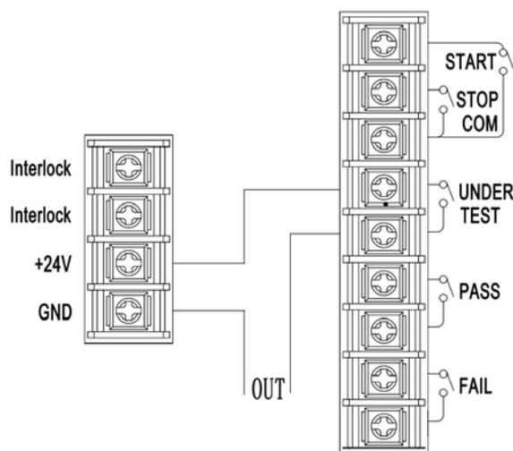
如上图所示，+24V 的一端与 UNDER TEST 的一端连接在一起，另外一端和 GND 组成输出端；当测试仪启动测试时，OUT 端的电压为 24V，测试结束时，没有电压。
