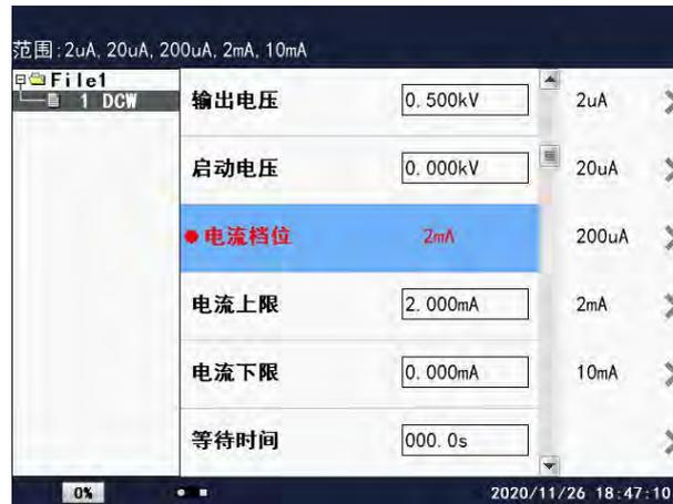
在此界面下，按对应的屏幕键即可改变档位值。不同型号的测试仪，其档位值是不同的，在液晶屏的左上角有设置值的范围值。
