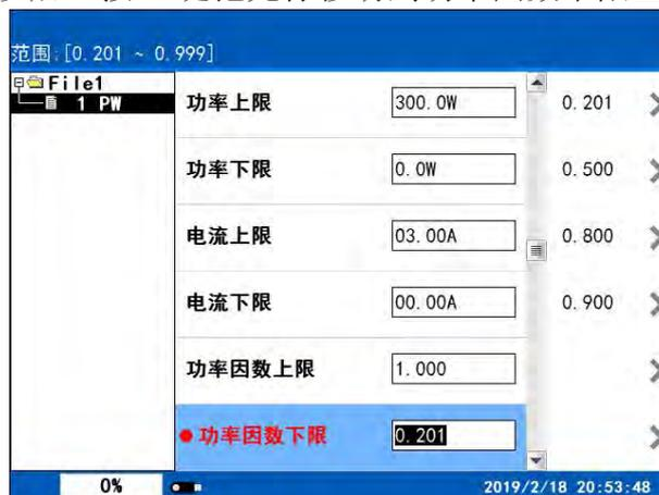
在此界面下，按相应的数字键或对应的屏幕键即可改变功率因数下限值。不同型号的测试仪，其功率因数下限值的范围是不同的，在液晶屏的左上角有设置值的范围值。输入的功率因数下限值在范围内是有效的，否则无效。例如：要设置 0.300 的功率因数上限值，按“0”、“.”、“3”、“0”、“0”即可。
