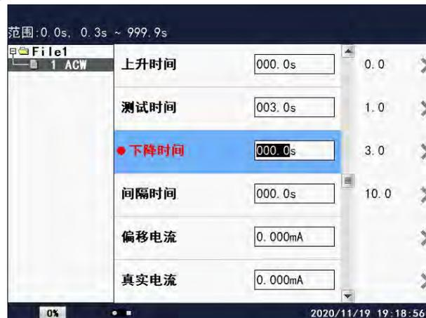
在此界面下，按相应的数字键或对应的屏幕键即可改变下降时间设置值。在液晶屏的左上角有测试时间范围值。例如：要设置 3.0s 的下降时间值，按“3”、“.”、“0”即可。
