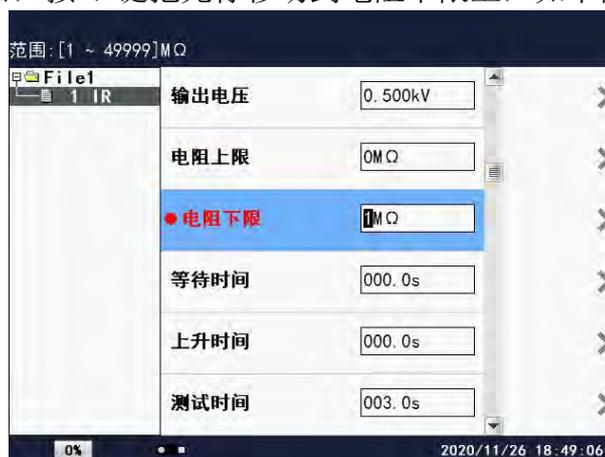
在此界面下，按相应的数字键或对应的屏幕键即可改变电阻下限值。不同型号的测试仪，其电阻下限的范围是不同的，在液晶屏的左上角有设置值的范围值。例如：要输出 50MΩ 的电阻上限值，按“5”、“0”即可。
