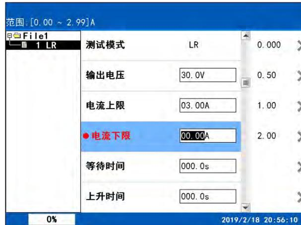
在此界面下，按相应的数字键或对应的屏幕键即可改变电流下限值。不同型号的测试仪，其电流下限值的范围是不同的，在液晶屏的左上角有设置值的范围值。输入的电流下限值在范围内是有效的，否则无效。例如：要设置 0.10A 的功率下限值，按“0”、“.”、“1”、“0”即可。
