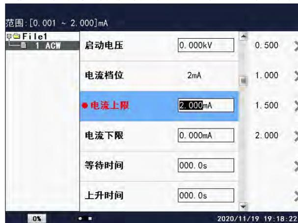
在此界面下，按相应的数字键或对应的屏幕键即可改变电流上限值。不同型号的测试仪，其电流上限的范围是不同的，在液晶屏的左上角有设置值的范围值。例如：要输出 1.200mA 的电压值，按“1”、“.”、“2”、“0”、“0”即可。
