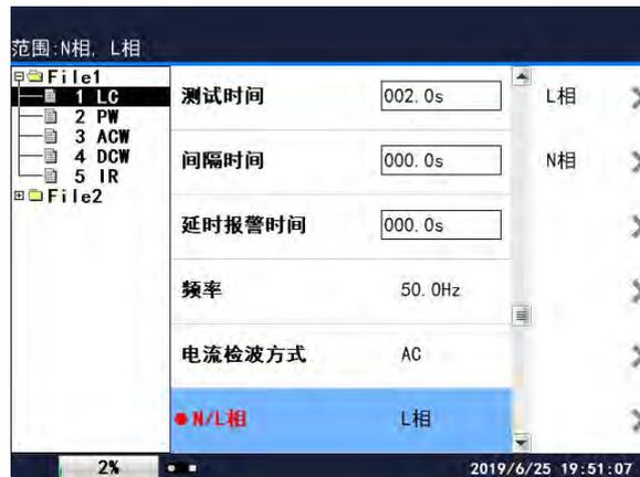
按相应的屏幕键即可改变设置值。设置为 N 相，那么测试时的电流为 N 相对地的漏电流；设置为 L 相，那么测试时的电流为 L 相对地的漏电流；
