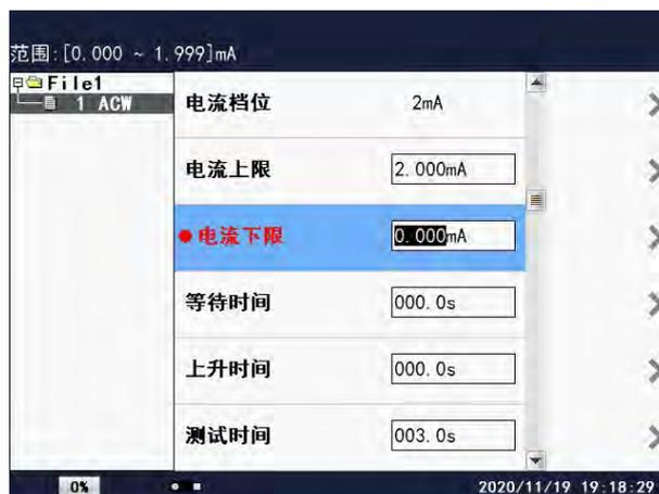
在此界面下，按相应的数字键或对应的屏幕键即可改变电流下限值。不同型号的测试仪，其电流下限的范围是不同的，在液晶屏的左上角有设置值的范围值。电流下限设置值要小于电流上限设置值。例如：要输出 0.200mA 的电压值，按“0”、“.”、“2”、“0”、“0”即可。
