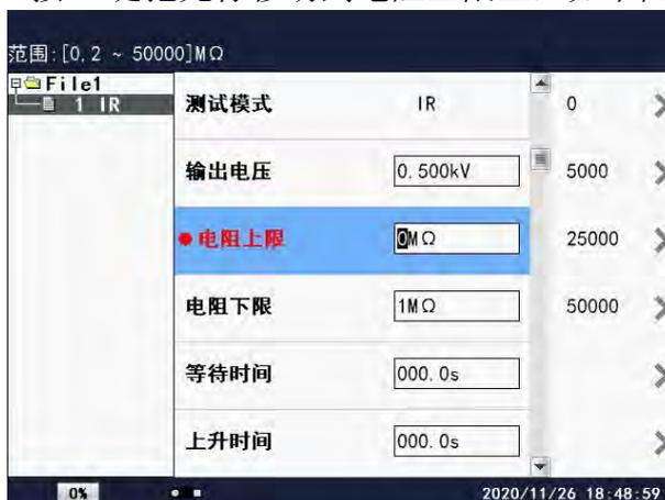
在此界面下，按相应的数字键或对应的屏幕键即可改变电阻上限值。不同型号的测试仪，其电阻上限的范围是不同的，在液晶屏的左上角有设置值的范围值。例如：要输出 500MΩ 的电阻上限值，按“5”、“0”、“0”、即可。
