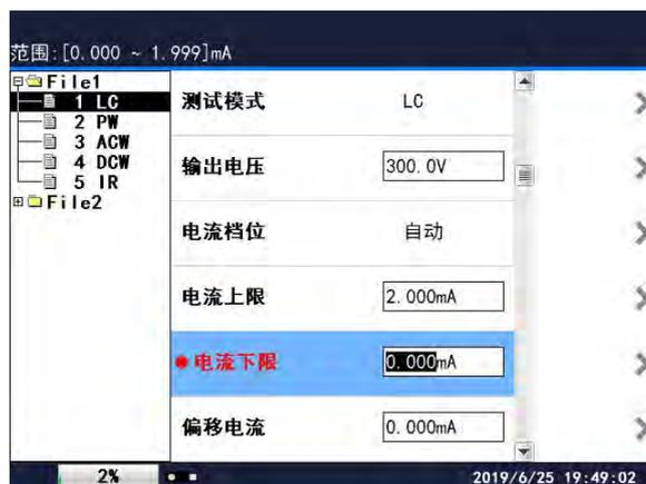
在此界面下，按相应的数字键或对应的屏幕键即可改变电流下限值。不同型号的测试仪，其电流下限的范围是不同的，在液晶屏的左上角有设置值的范围值。电流下限设置值要小于电流上限设置值。例如：要输出 0.200mA 的电压值，按“0”、“.”、“2”、“0”、“0”即可。当回路中的电流小于电流下限设置值时，测试仪会给出报警并切断高压输出。这说明测试附件和被测试品没有连接好。
