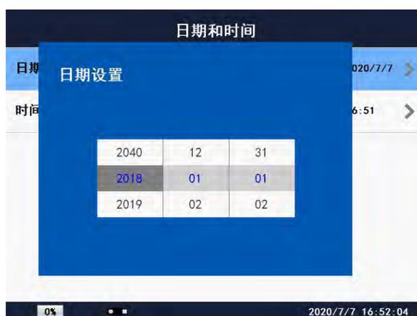
时间设置：按时间对应的功能键即可进入到时间设置界面，按“←”“→”键改变设置项；按“↑”“↓”键或旋转拨盘改变年时、分的设置值。设置完成后按“ENTER”键保存设置。
