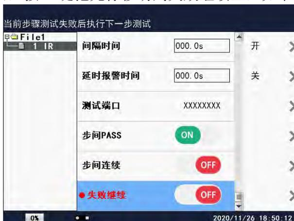
当设置为开时，当前步测试失败时，测试仪会自动进行下一步的测试；设置为关，当前步测试失败时，测试仪立即停止测试并报警。
