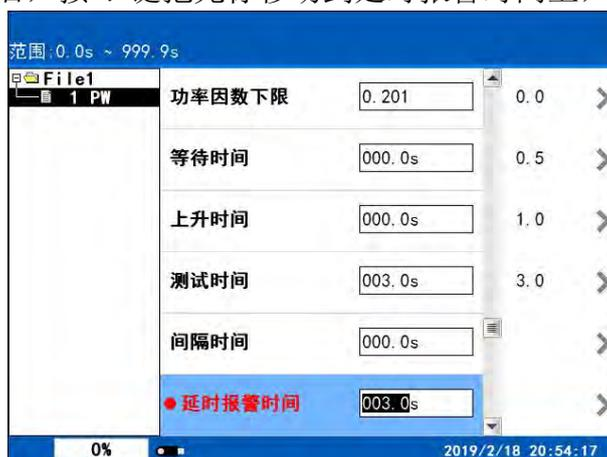
在此界面下，按相应的数字键或对应的屏幕键即可改变延时报警时间设置值。在液晶屏的左上角有延时报警时间范围值。例如：要设置 3.0s 的间隔时间值，按“3”、“.”、“0”即可。
