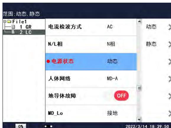
电源状态有两个状态可设置：动态和静态。动态是指测试仪输出的电源 N、L 相供给被测试品，被测试品得到电源可工作。静态是指测试仪输出的电源 N、L 只有一相，被测试品不工作。
