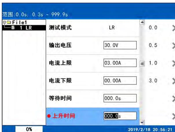
在此界面下，按相应的数字键或对应的屏幕键即可改变上升时间设置值。在液晶屏的左上角有上升时间范围值。例如：要设置 3.0s 的上升时间值，按“3”、“.”、“0”即可。
