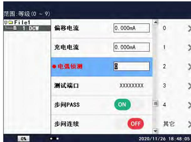
电弧检测设置为 0，在测试过程中，被测试体打火或出现闪络现象，测试仪检测不出来；若设置不为 0 测试仪根据设置值而检测出不同的打火或闪络等级。
