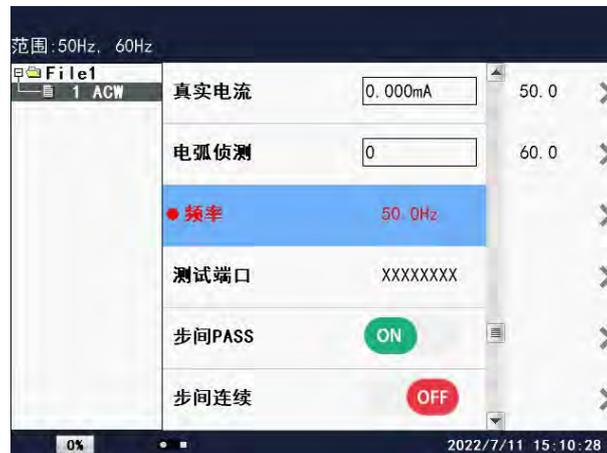
在此界面下，按相应的数字键或对应的屏幕键即可改变频率设置值。在液晶屏的左上角有频率范围值。
