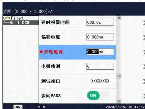
在此界面下，按相应的数字键或对应的屏幕键即可改变充电电流设置值。例如：要输出 0.200mA 的电压值，按“0”、“.”、“2”、“0”、“0”即可。
