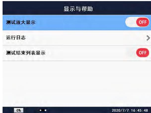
**测试放大显示：**当设置为 ON 时，在测试时，导航栏去掉，屏幕的右侧全部为测试界面。
