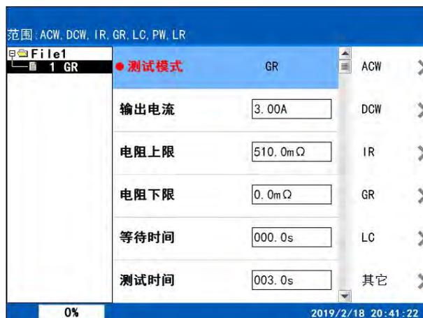
参数设置过程中，按“↓”键或拨盘改变设置项。等待测试界面下按“ENTER”键，可直接进入到当前步骤参数设置界面。
