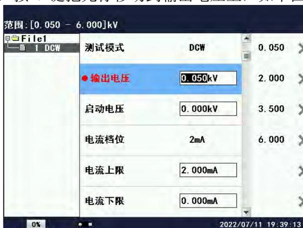
在此界面下，按相应的数字键或对应的屏幕键即可改变输出电压值。不同型号的测试仪，其输出电压的范围是不同的，在液晶屏的左上角有设置值的范围值。输入的电压值在范围内是有效的，否则无效。例如：要输出 4.750kV 的电压值，按“4”、“.”、“7”、“5”、“0”即可。
