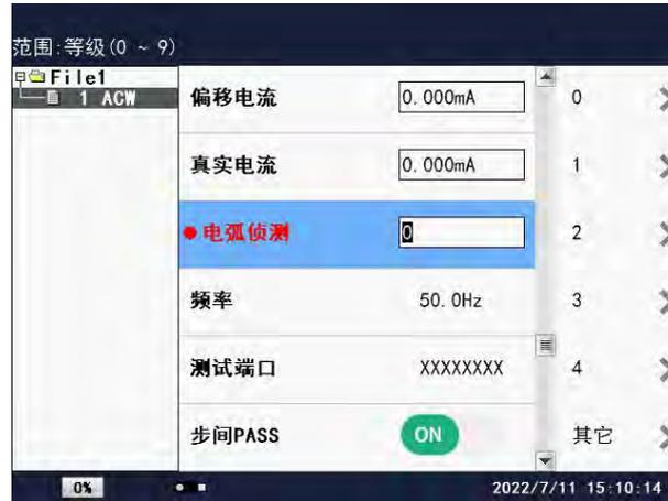
电弧侦测设置为 0，在测试过程中，被测试体打火或出现闪络现象，测试仪检测不出来；若设置不为 0 测试仪根据设置值而检测出不同的打火或闪络等级。当电弧侦测设置设置为 1-9，对应的电弧峰值分别为：**20mA、18mA、16mA、14mA、12mA、10mA、7.7mA、5.5mA、2.8mA。**
