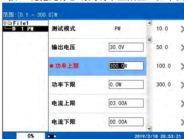
在此界面下，按相应的数字键或对应的屏幕键即可改变功率上限值。不同型号的测试仪，其功率上限值的范围是不同的，在液晶屏的左上角有设置值的范围值。输入的功率上限值在范围内是有效的，否则无效。例如：要设置 200.0W 的功率上限值，按“2”、“0”、“0”、“.”、“0”即可。
