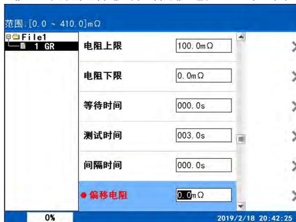
在此界面下，按相应的数字键即可改变测试偏移电阻设置值。偏移电阻是为了减去夹具附件上的电阻而设置的。把附件短接后，启动测试仪，液晶屏显示夹具附件上的电阻值，把此电阻值输入到偏移电阻中即可在测试时减去偏移电阻。
