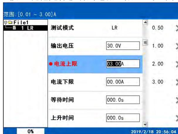
在此界面下，按相应的数字键或对应的屏幕键即可改变电流上限值。不同型号的测试仪，其电流上限值的范围是不同的，在液晶屏的左上角有设置值的范围值。输入的电流上限值在范围内是有效的，否则无效。例如：要设置 3.00A 的功率下限值，按“3”、“.”、“0”、“0”即可。
