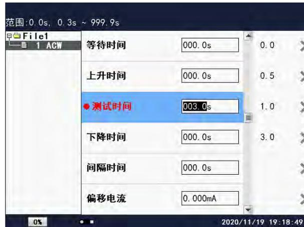
在此界面下，按相应的数字键或对应的屏幕键即可改变测试时间设置值。在液晶屏的左上角有测试时间范围值。例如：要设置 3.0s 的测试时间值，按“3”、“.”、“0”即可。当测试时间设置为 0 时，测试仪不判断测试时间是否到，直至测试失败或“STOP”键按下。
