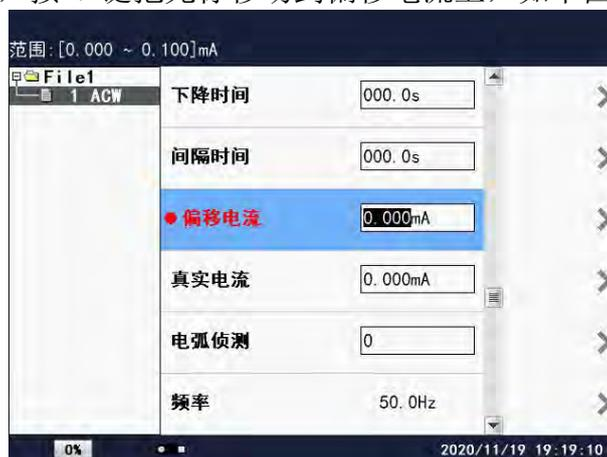
在此界面下，按相应的数字键即可改变测试偏移电流设置值。偏移电流是为了减去夹具上的漏电流而设置的。在夹具上不接负载，启动测试仪，测试仪显示一个电流值，此值即为偏移电流；输入即可。
