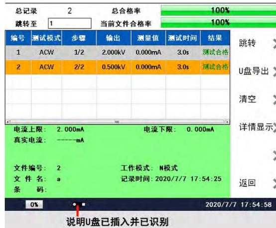
在上图中，按屏幕键“U 盘导出”，测试仪把结果导出到 U 盘中，在 U 盘中是以 EXCEL 表格的形式进行存储的，存储的 EXCEL 结果如下：
