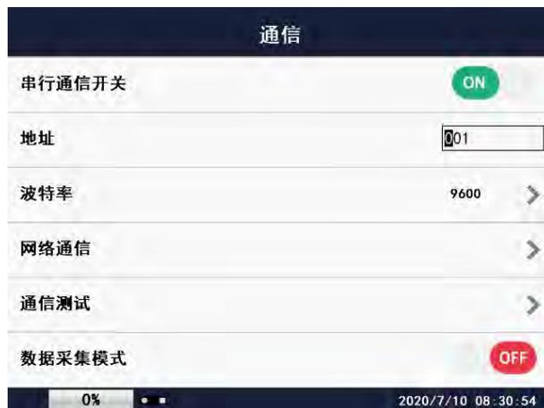
通讯地址设置；范围：1~10。在设置此项参数时必须确保在同一个通讯网络内，仪器地址必须唯一！按“↓”方向键或拨盘改变设置项，设置完成后按“ENTER”键保存设置。
