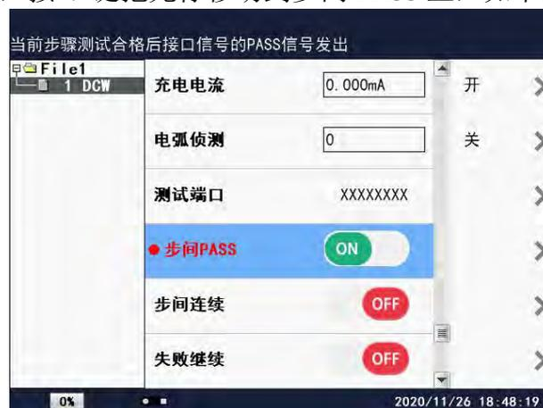
当设置为开时，当前步测试完后，PLC 会给出 PASS 信号；如果设置为关，当前步测试完以后，PLC 不会给出 PASS 信号。
