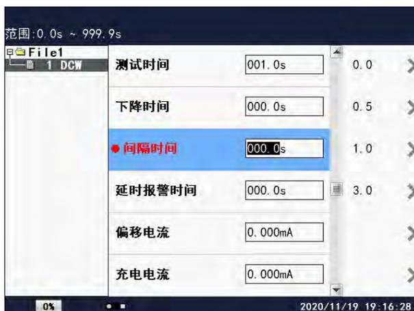
在此界面下，按相应的数字键或对应的屏幕键即可改变间隔时间设置值。在液晶屏的左上角有间隔时间范围值。例如：要设置 3.0s 的间隔时间值，按“3”、“.”、“0”即可。
