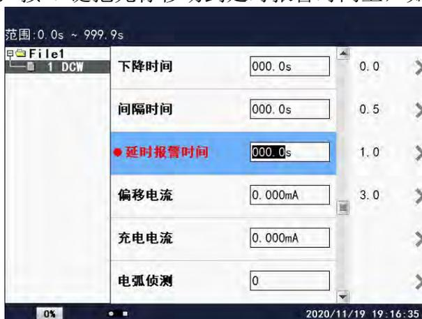
在此界面下，按相应的数字键或对应的屏幕键即可改变延时报警时间设置值。在液晶屏的左上角有延时报警时间范围值。例如：要设置 3.0s 的延时报警值，按“3”、“.”、“0”即可。
