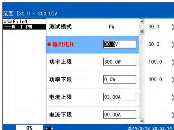
在此界面下，按相应的数字键或对应的屏幕键即可改变输出电压值。不同型号的测试仪，其输出电压的范围是不同的，在液晶屏的左上角有设置值的范围值。输入的电压值在范围内是有效的，否则无效。例如：要输出 220.0V 的电压值，按“2”、“2”、“0”、“.”、“0”即可。
