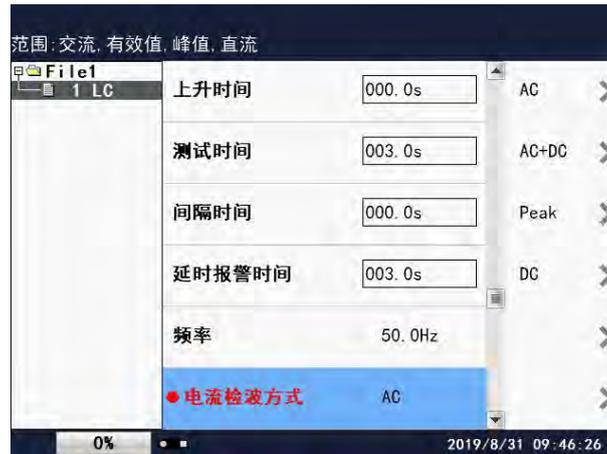
电流检波方式分为四种：交流、有效值、峰值或直流；按相应的屏幕键即可改变设置值。
