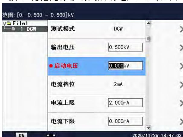
在此界面下，按相应的数字键或对应的屏幕键即可改变启动电压值。不同型号的测试仪，其启动电压的范围是不同的，在液晶屏的左上角有设置值的范围值。启动电压的
