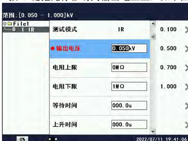
在此界面下，按相应的数字键或对应的屏幕键即可改变输出电压值。不同型号的测试仪，其输出电压的范围是不同的，在液晶屏的左上角有设置值的范围值。输入的电压值在范围内是有效的，否则无效。例如：要输出 0.500kV 的电压值，按“0”、“.”、“5”、“0”、
