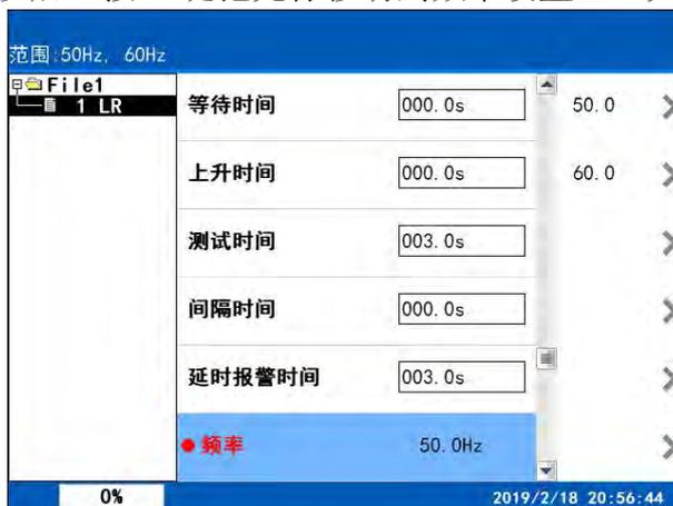
在此界面下，按相应的屏幕键即可改变频率设置值。在液晶屏的左上角有频率范围值。
