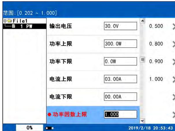
在此界面下，按相应的数字键或对应的屏幕键即可改变功率因数上限值。不同型号的测试仪，其功率因数上限值的范围是不同的，在液晶屏的左上角有设置值的范围值。输入的功率因数上限值在范围内是有效的，否则无效。例如：要设置 0.900 的功率因数上限值，按“0”、“.”、“9”、“0”、“0”即可。
