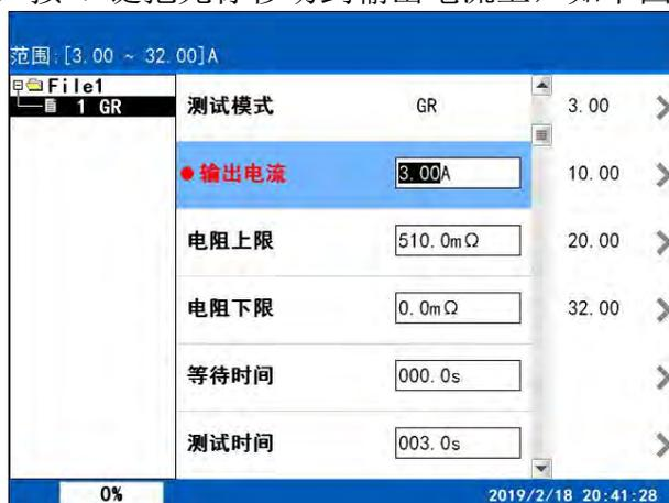
在此界面下，按相应的数字键或对应的屏幕键即可改变输出电流值。不同型号的测试仪，其输出电流值的范围是不同的，在液晶屏的左上角有设置值的范围值。输入的电流值在范围内是有效的，否则无效。例如：要输出 10.00A 的电流值，按“1”、“0”、“.”、“0”、“0”即可。
