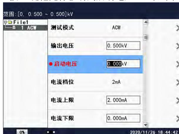
在此界面下，按相应的数字键或对应的屏幕键即可改变启动电压值。不同型号的测试仪，其启动电压的范围是不同的，在液晶屏的左上角有设置值的范围值。启动电压的设置值一定要小于输出电压设置值，否则无效。例如：要输出 0.300kV 的电压值，按“0”、“.”、“3”、“0”、“0”即可。
