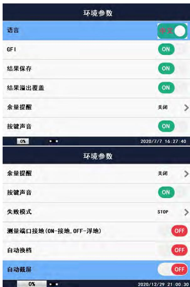
环境参数设置的参数共 7 项：系统语言；GFI 保护；结果保存；结果溢出覆盖；余量提醒；按键声音；失败模式；测试端口接地；
