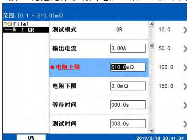
在此界面下，按相应的数字键或对应的屏幕键即可改变电阻上限值。不同型号的测试仪，其电阻上限的范围是不同的，在液晶屏的左上角有设置值的范围值。例如：要输
