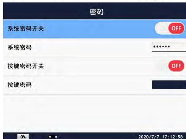
系统密码开关：范围：ON、OFF。按“ENTER”键或“→”方向键切换打开或关闭。系统密码开关设置为“OFF”，进入系统参数设置时，不需要输入密码；设置为“ON”，进入系统参数设置时，需要输入系统密码。
