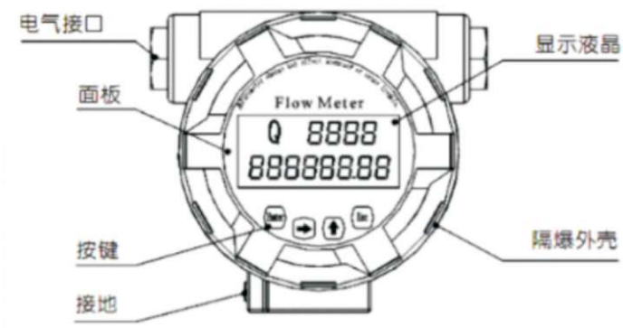
图3.1 转换器基本结构图
