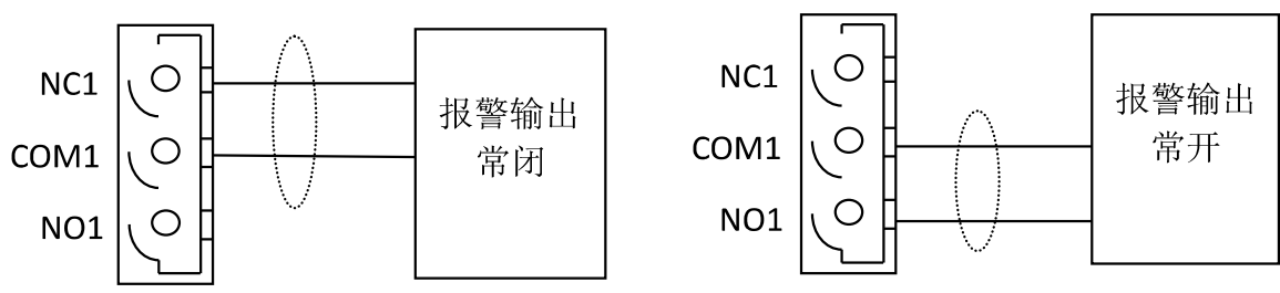
图 4-2 报警接线示意图
