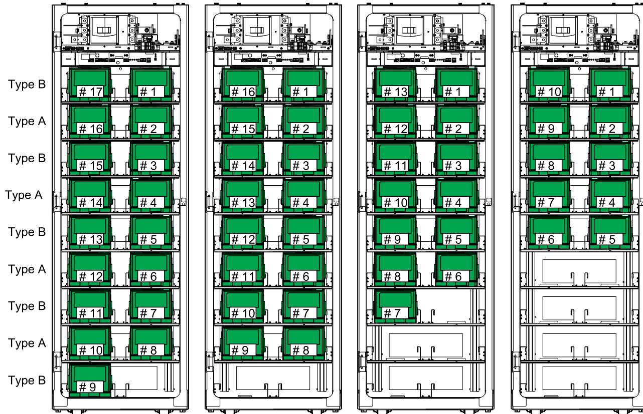
电池柜电池配置 (带 17、16、13 和 10 个电池模块)
