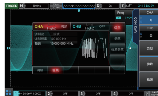
10 内置等性能双通道50MHz函数/任意波形发生器
