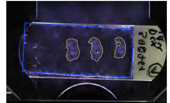
AI 样品识别系统可以识别您的样品载体，并自动检测样本区域。样品由德国德累斯顿工业大学 Carl Gustav Carus 医学系解剖学研究所的 M. Schmidt 提供。
