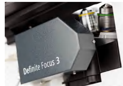
Definite Focus 3 集成在 AxiObserver 7 的物镜转盘。
