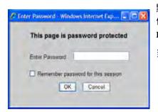
默认的出厂密码为 "agilent"。不过,用户可以 修改此密码 (按仪器前面板键 System, I/O Config, Reset Web Password 改变密码)。
