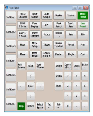
点击虚拟前面板的按钮效仿相应的前面板按键操作。在此面板左侧的按键 Key 1 到 Key 7,效仿各自的软按键操作。
