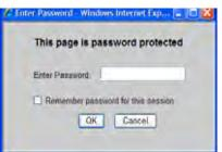
默认的出厂密码为 "agilent"。不过,用户可以修改 此密码 (按仪器前面板键 System, I/O Config, Reset Web Password 改变密码)。
