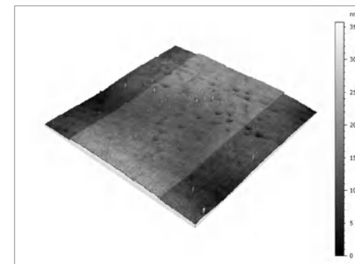
8 nm 台阶高度标样、高度图，C Epiplan-Apochromat 50×/0.95 物镜
