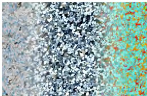
贝瑞亚砂岩的复合多通道采集，显示了明场采集（左），圆偏光（最大双折射）采集（中），以及相位分割分析结果（右）。机器学习分割用于分类孔隙（金色）、石英（浅蓝色）、方解石（深蓝色）、云母（红色）和不透明矿物（绿色和黄色）。
