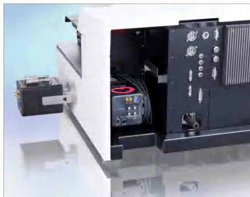
Lattice Lightsheet 7 配备两台滨松 ORCA-Fusion sCMOS 相机
