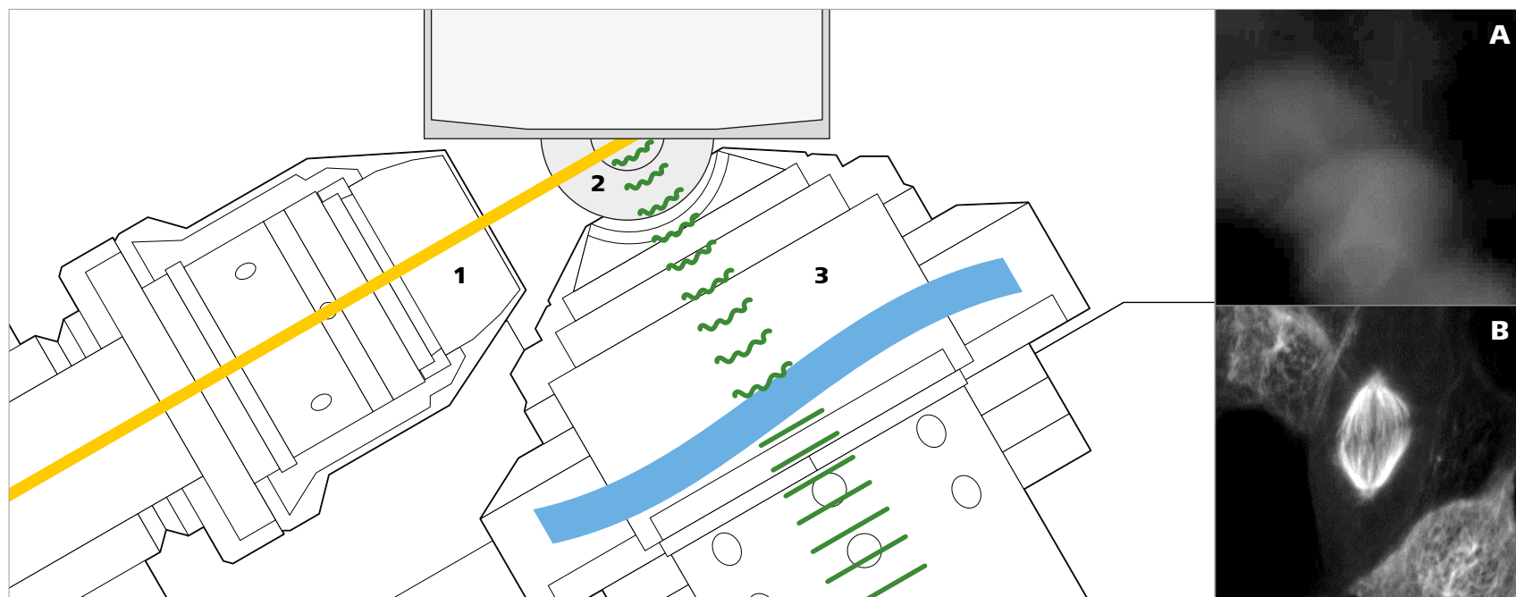
带有激发物镜（1）、半月形透镜（2）和含自由波前光学器件的检测物镜（3）的样品载具和核心光学模块示意图。示例显示了没有（A）和带有折射率校正（B）的成像。
