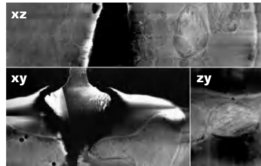
对齐和处理好的气孔 FIB 序列图像。正交投影视图中显示了成像气孔的不同视角。
