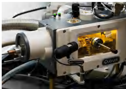
安装在蔡司 Crossbeam 上的冷冻制备室
