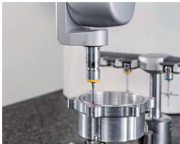
**零部件表面形位的高精度检测**
