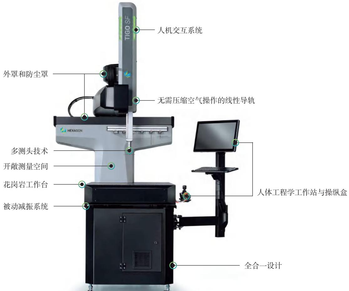
TIGO SF 测量设备的附加选项不仅可以让测量设备适应恶劣的测量环境，而且能够为特殊应用及生产集成测量任务提供最佳配置。
