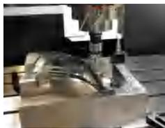
中小型模具、铸件加工定位和三维曲面测量
