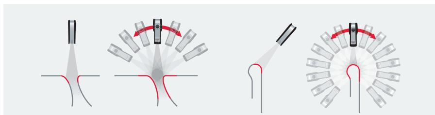
基于激光光切技术。操作者或机械手臂将传感器移动至待测量轮廓的上方。同时智能图像处理系统从不同的视角连续采集轮廓的片段，并拟合成一个完整轮廓。CALIPRI 专利技术可自动补偿传感器的倾斜和扭转，使得测量结果具有高重复性且不受人为因素影响。
