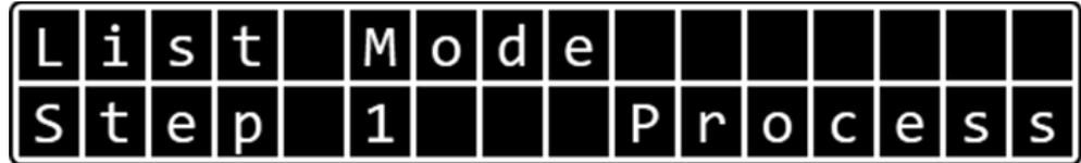
以List步骤依次执行测试。若每步中设定判定条件并满足条件时，测试将停止并显示该步执行失败“Fail”。
