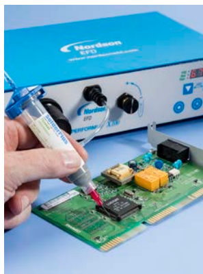
在PCB板上点涂SolderPlus®焊锡膏。
