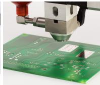
可以轻松且可重复地实现珠状非接触式微量点胶,并在难以接触或精细表面进行填充。
