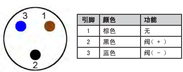
M8胶阀驱动电缆引脚位置
