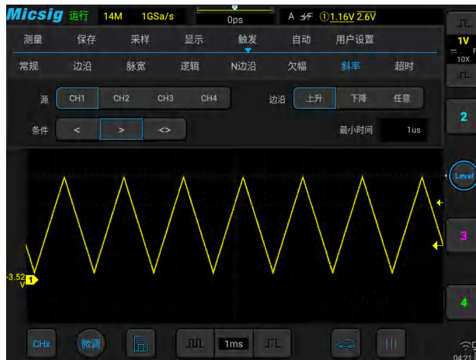
图7-27 斜率触发设置菜单
