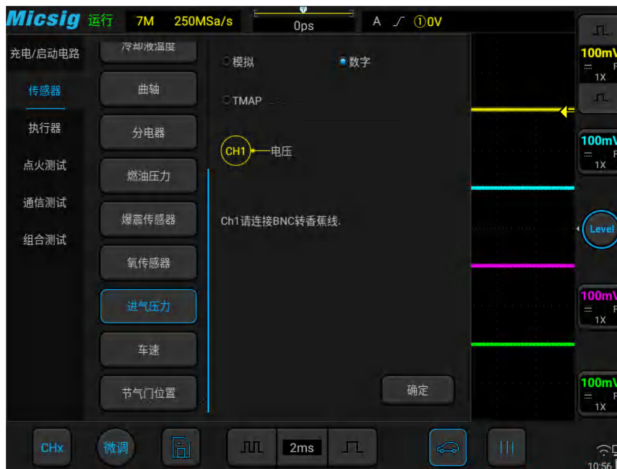
图3-25 进气压力传感器测试
