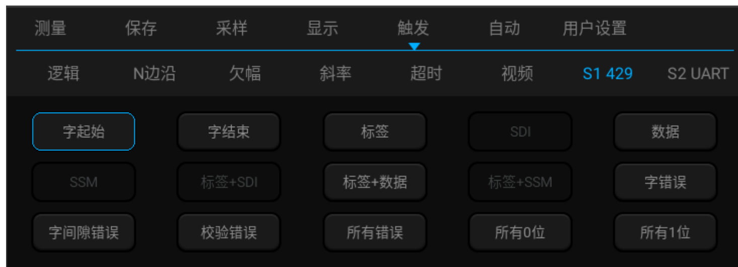
图13-27 ARINC429 触发方式配置菜单
