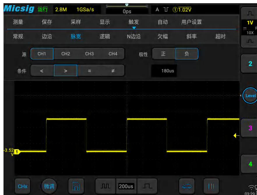
图7-15 负极性脉冲电平翻转
