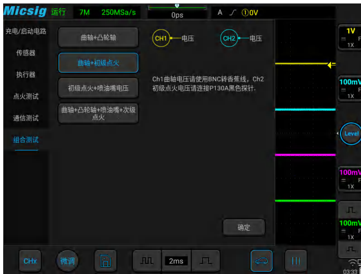
图3-56 曲轴+初级点火组合测试
