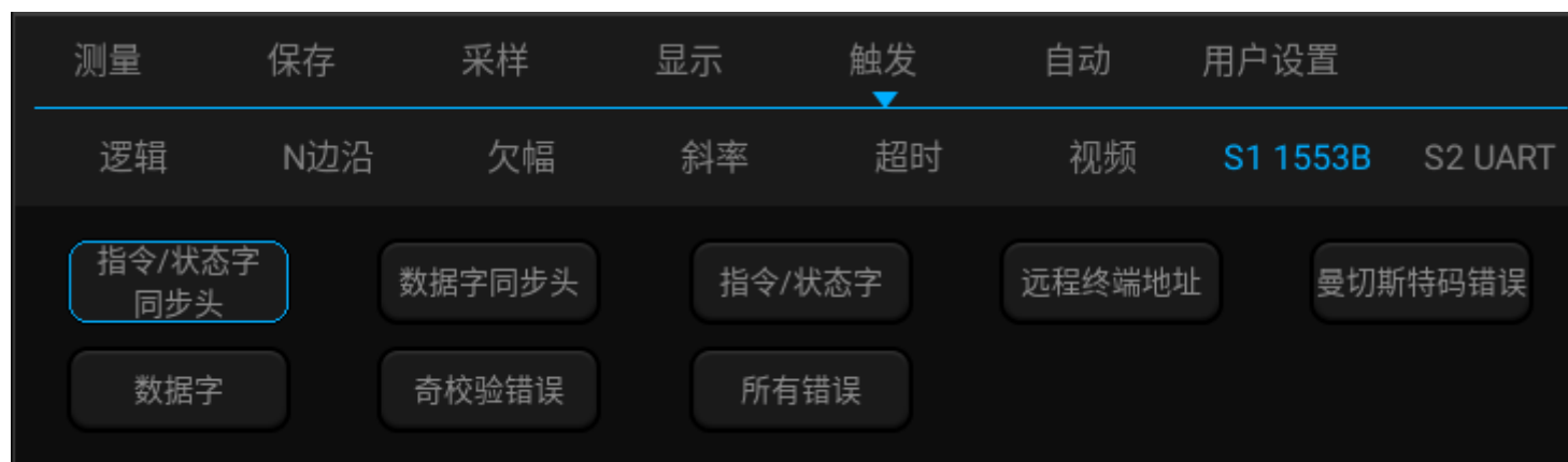
图13-31 1553B 触发方式配置菜单
