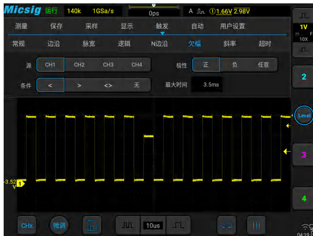
图7-25 欠幅触发设置菜单
