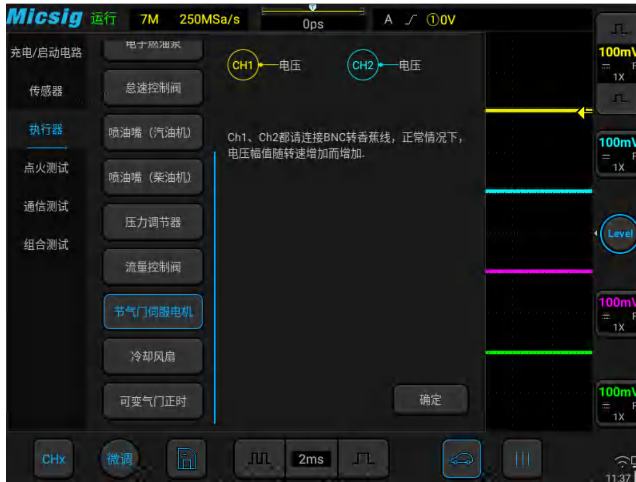
图3-39 节气门伺服电机测试
