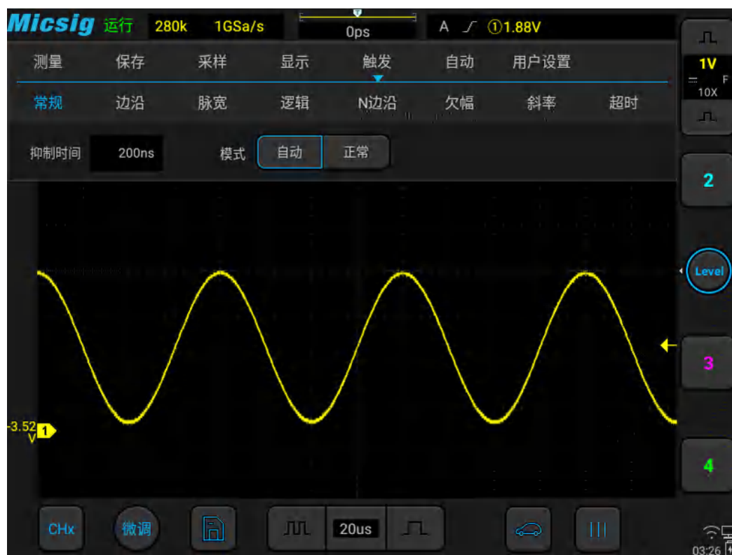
图7-5 示波器触发模式设置
