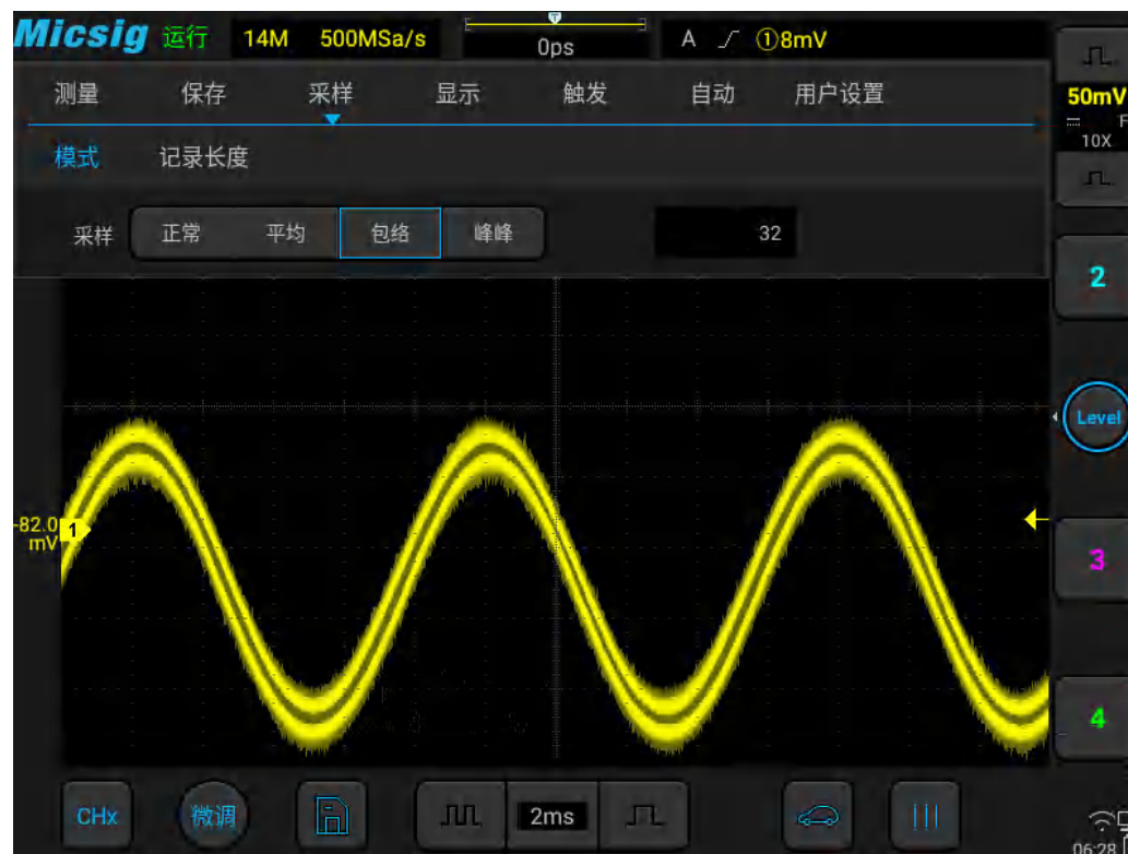
图12-8 包络采样模式（32）下的调幅信号
