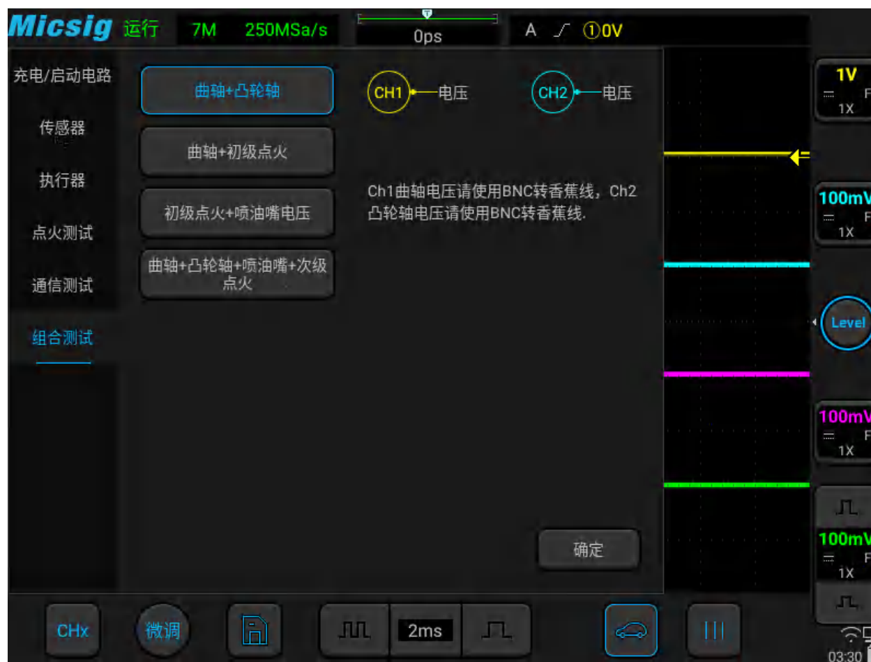
图3-55 曲轴+凸轮轴组合测试
