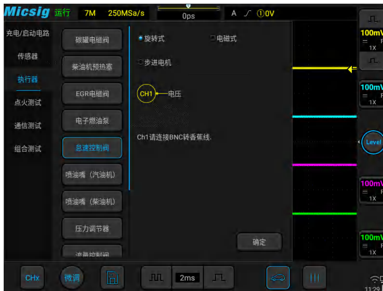
图3-34 怠速控制阀测试
