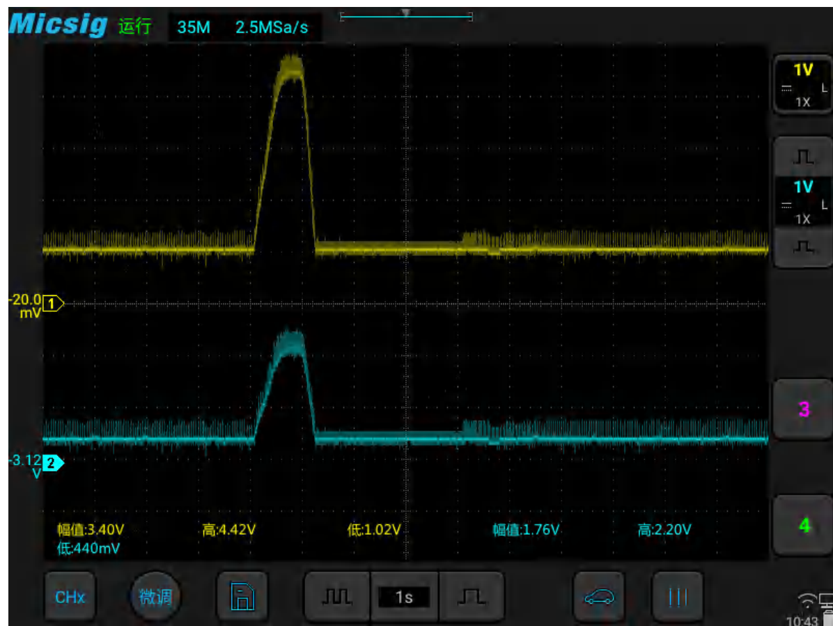
图3-12 油门踏板传感器的实测图
