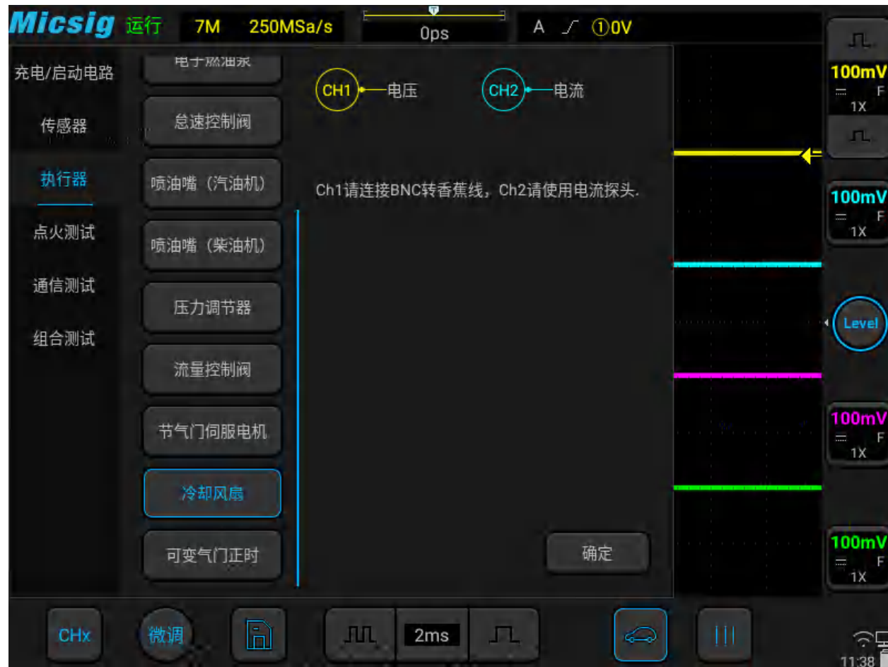
图3-40 冷却风扇测试
