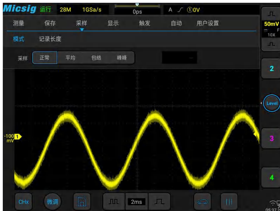
图12-5 带毛刺的正弦波，正常采样模式
