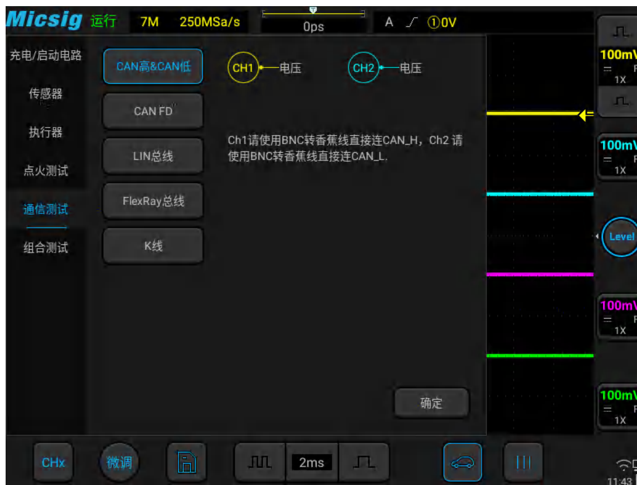
图3-49 CAN 总线测试
