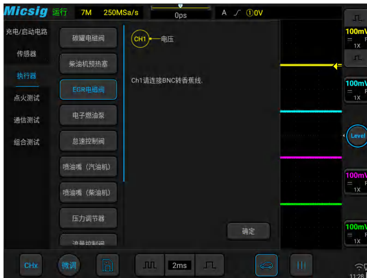
图3-32 EGR 电磁阀测试
