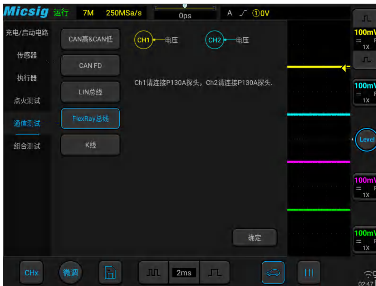
图3-53 FlexRay 总线测试
