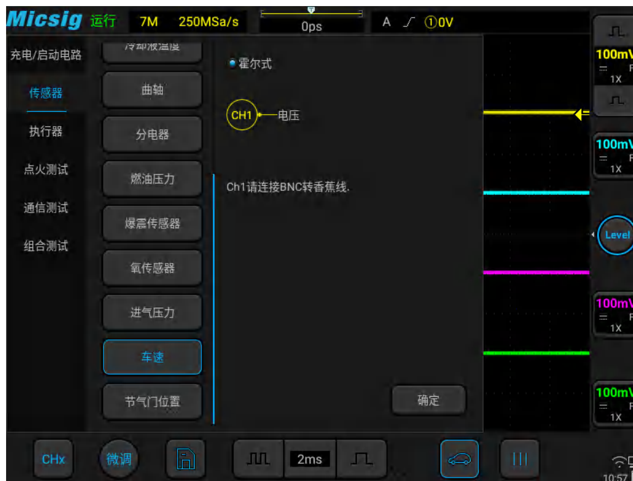
图3-26 车速传感器测试
