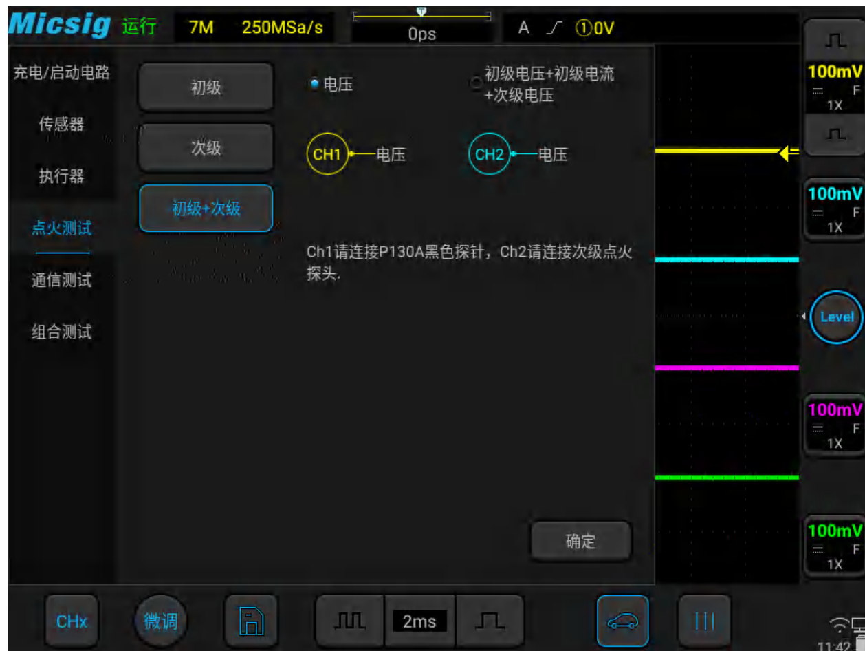
图3-47 初级+次级点火测试
