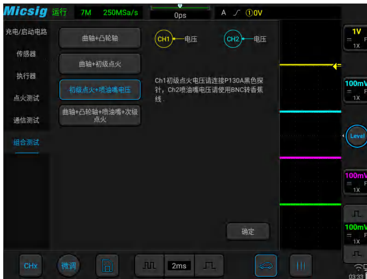
图3-57 初级点火+喷油嘴电压组合测试
