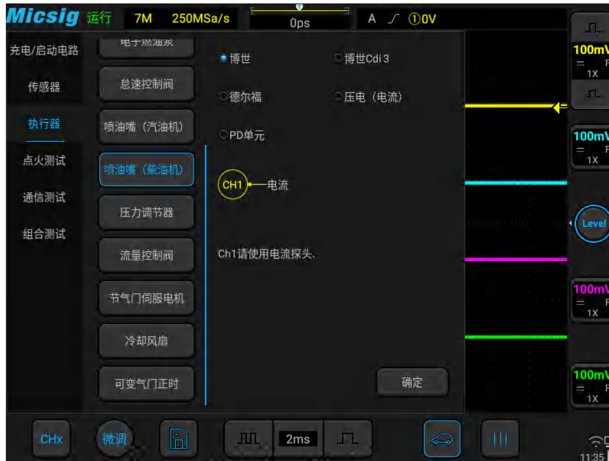
图3-36 喷油嘴（柴油机）测试
