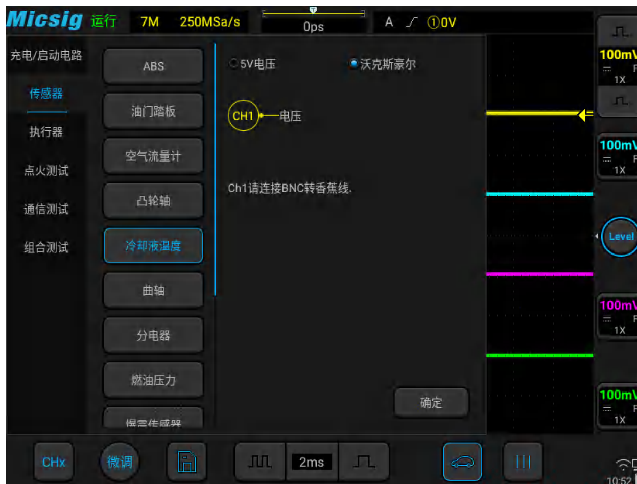
图3-16 冷却液温度传感器测试
