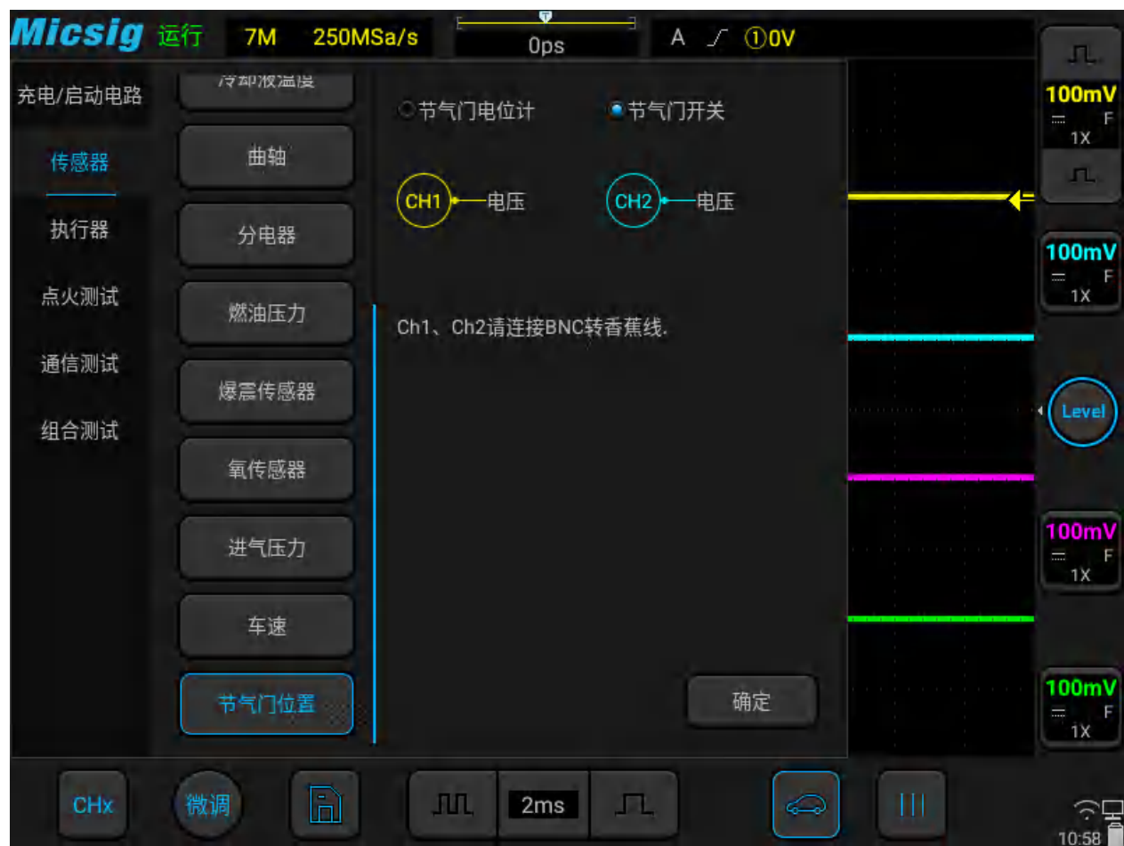
图3-27 节气门位置传感器测试
