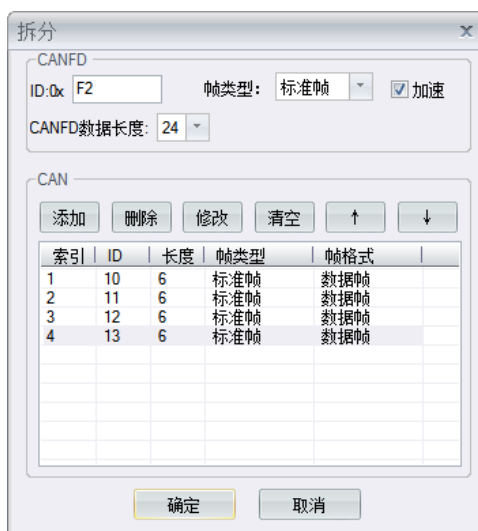
图 4.38 24 字节 CANFD 拆分为 4 个 6 字节 CAN 设置
