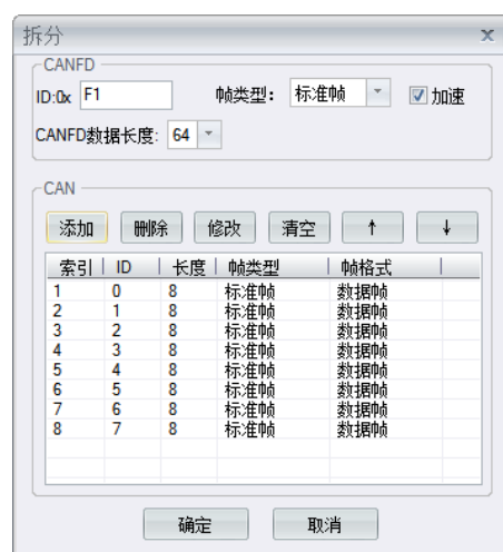
图 4.36 64 字节 CANFD 拆分 8 个 8 字节 CAN 设置
