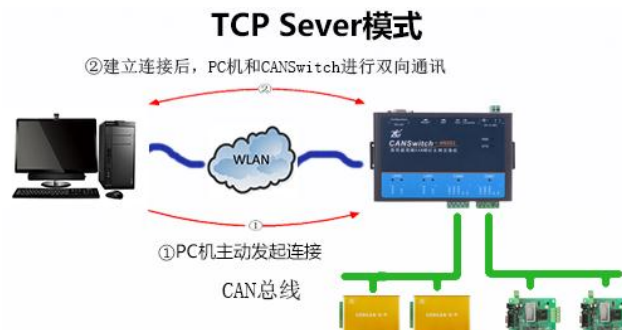
图 4.12 TCP Sever 模式通讯示意图
