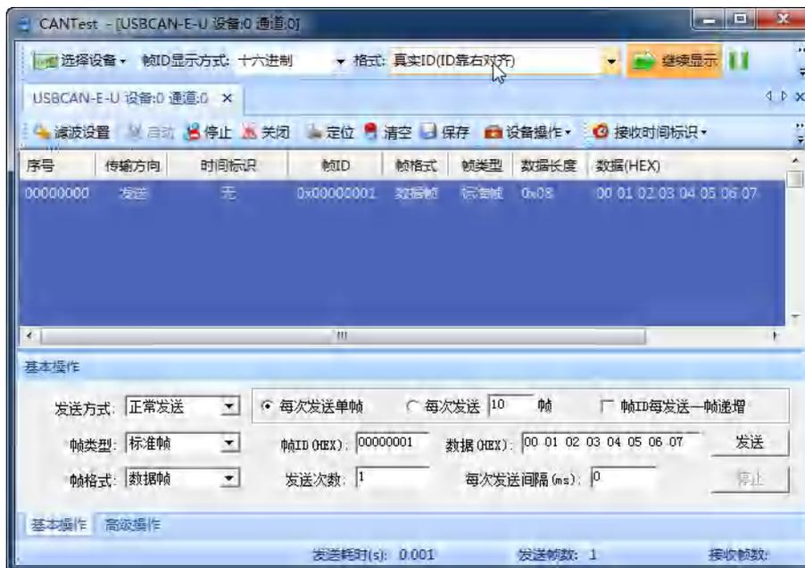
图 4.38 USBCAN 发送数据 1
