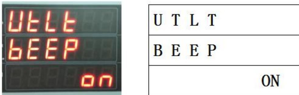
进入系统设置界面, 第一行数码管闪烁, 此时按◀▶键, 可选择系统设置项目, UTLT/PLC/COM/BAR 可选。按 SHIFT 键后切换到第二行数码管闪烁, 此时按◀▶键可以切换当前设置项目内的子设置项目, 再按 SHIFT 键又会切换到第一行数码管闪烁。▲▼键用于修改第三行数据。
