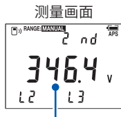
线电压 (第2次测量)
