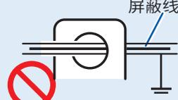
无法正确测量被接地屏蔽的导体。
