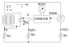
測定原理図(3電極法)
