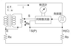
測定原理図(2電極法)
