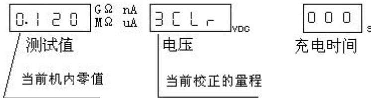
图 3-2 正在清零校准，测试值显示器显示当前量程的零值（mV）
