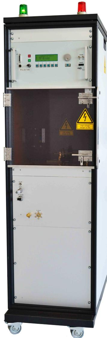
Der Stossstromgenerator Typ PG10-7k erzeugt Blitzstoßströme mit der Kurvenform 10/350 $\mu$ s nach IEC, VDE etc..
