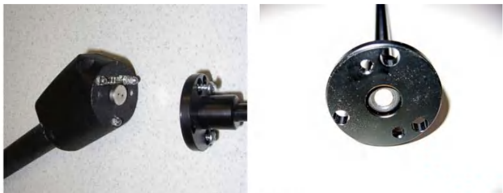
插图 19: 嗅探器手柄中的烧结过滤器
