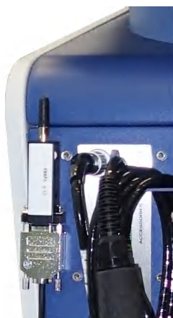
插图 21: 可以使用随附的胶带将发射机固定到一个可用位置。
