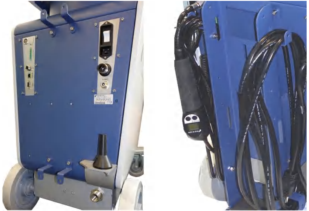
插图 8: 固定在设备上或可选配钢筒架上的挂钩
