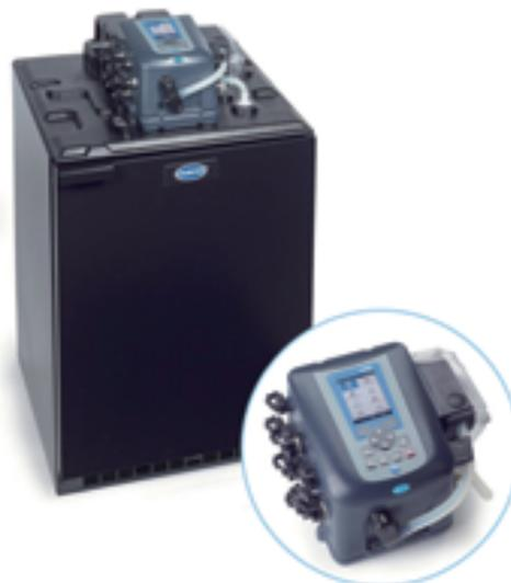
冷藏式采样器在现场固定使用，能在潮湿和腐蚀的环境下正常工作。制冷机为不锈钢材料。通过空气感应温度调节控制冷藏温度，高效压缩机、冷凝器、蒸发器和严密的泡沫塑料隔离装置保证最佳的4°C水样温度。强制空气吹扫和前部通风使得采样器可以灵活地安放在墙旁边，或者是采样器外罩中。键盘、开关、显示屏都具有防水、防腐蚀功能，密封的连接件和泵轴保证了采样器不受所处环境的影响。
