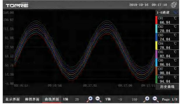
■ 同样的测试条件下用0.1S的速度采集就可以捕捉更多的变化点,曲线也更加圆滑
